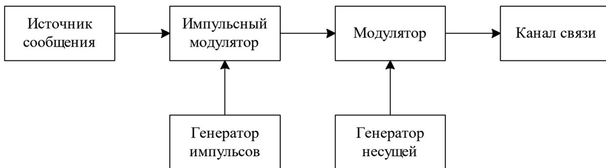
Рис. 4.3. Структурная схема передающей части импульсной системы связи
