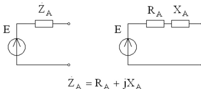
Рисунок 5.1 – Эквивалентная схема антенной цепи
