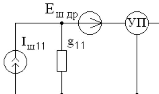
Рисунок 2.2 – Обобщенная эквивалентная шумовая схема УП
