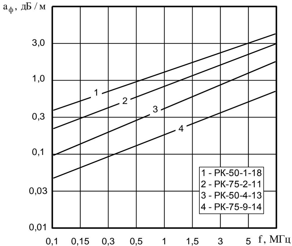
Рисунок 3.2 – Частотные зависимости погонного затухания  $a_\phi$  радиочастотных кабелей
