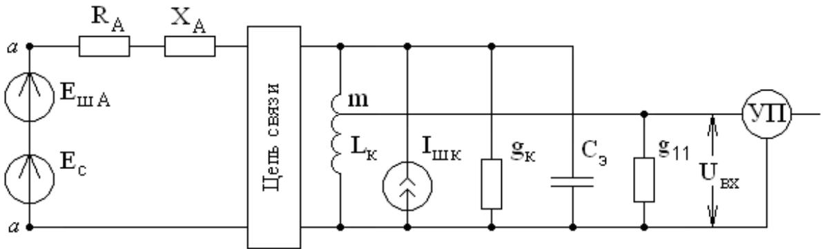
Рисунок 5.4 – Эквивалентная схема ненастроенной антенной цепи и преселектора
