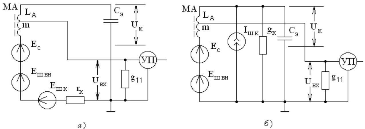
Рисунок 6.1 – Эквивалентные схемы ВЦ с магнитной антенной
