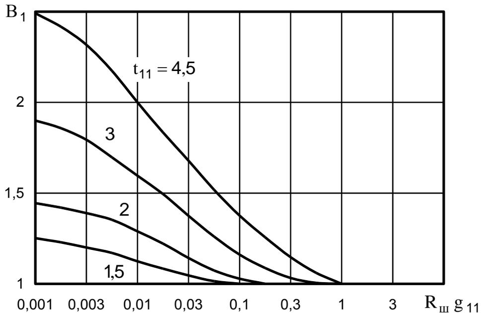
Рисунок 4.4 – Зависимость от произведения  $R_{\text{ш}}g_{11}$  выигрыша  $B_1$  в коэффициенте шума для разных значений  $t_{11}$  при условии  $g_k \ll g_{11}$
