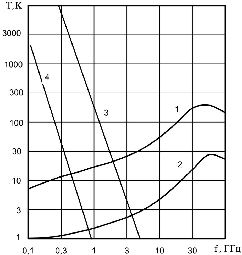
Рисунок 2.3 – Зависимость составляющих температуры антенны от частоты.
