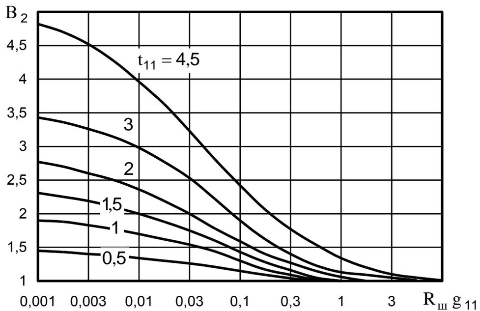
Рисунок 4.6 – Зависимость от произведения  $R_{ш}g_{11}$  выигрыша  $B_3$  в коэффициенте шума для разных значений  $t_{11}$  при условии  $g_K \ll g_{11}$
