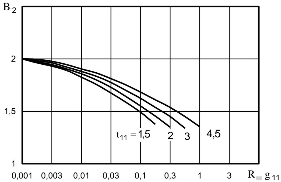
Рисунок 4.5 – Зависимость от произведения  $R_{ш}g_{11}$  выигрыша  $B_2$  в коэффициенте шума для разных значений  $t_{11}$  при условии  $g_K \ll g_{11}$
