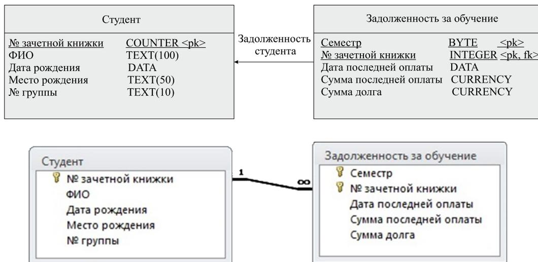
Рис. 4.17 – Пример сгенерированной физической ER-модели и схемы БД
