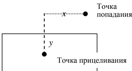
Для расстояния, с которого запускаются ракеты, оба отклонения независимы, нормально распределены относительно точки прицеливания с  $m=0$ ,  $\sigma_x = 60$  м,  $\sigma_y = 30$  м. Бомбардировщик при каждом заходе выпускает 6 ракет.
