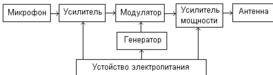
Рис. 3.15. Структурная схема акустической закладки.
