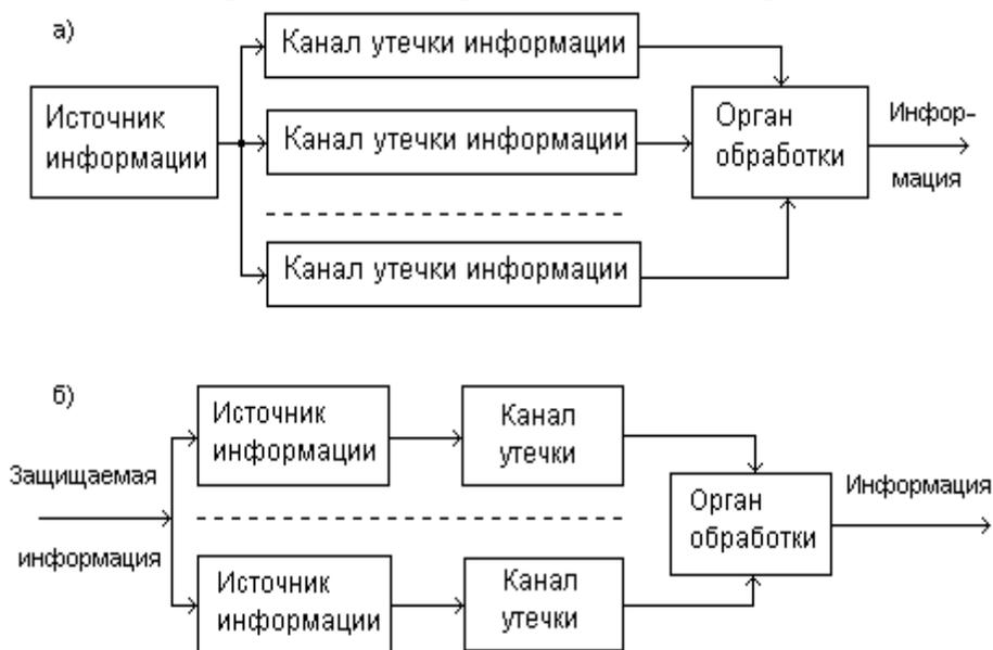
Рис. 4.10. Варианты комплексного использования каналов утечки.
