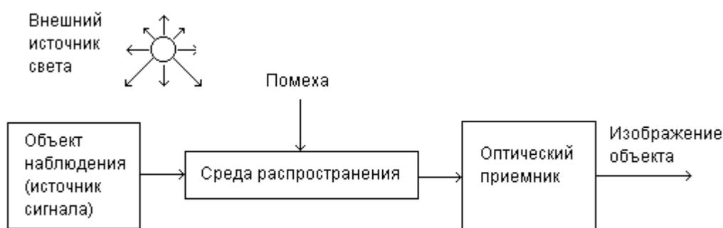
Рис. 4.3. Структура оптического канала утечки информации.
