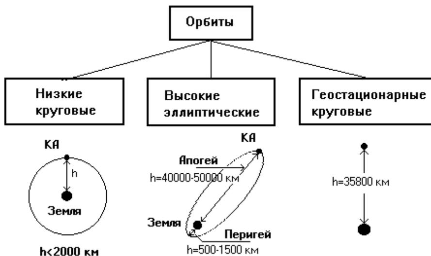
Рис. 2.5. Виды орбит разведывательных ИСЗ.
