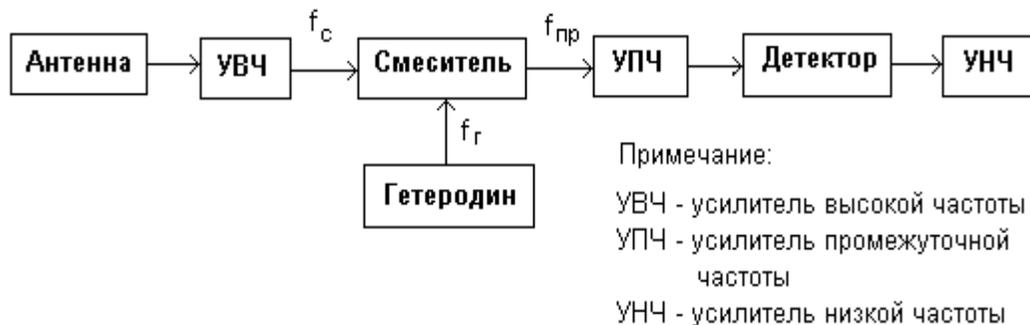
Рис. 3.11. Структура супергетеродинного приемника.
