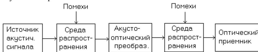
Рим. 4.8. Структурная схема акусто-оптического канала утечки информации,
