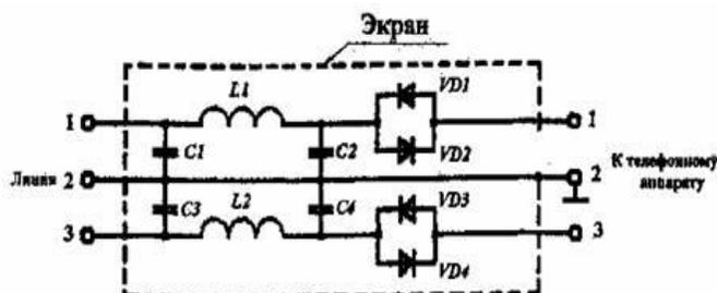
Рисунок 5.3 - Схема устройства защиты телефонных аппаратов типа «Гранит», сочетающего фильтр и ограничитель
