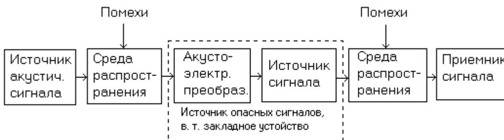
Рис. 4.7. Структура акусто-радиоэлектронного канала утечки информации.
