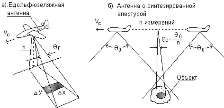
Рис.3.7. Принцип работы радиолокатора бокового обзора.
