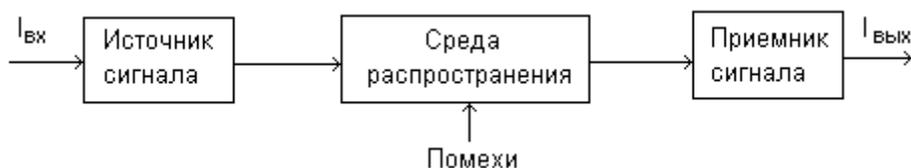
Рис. 4.1. Структура канала передачи информации.
