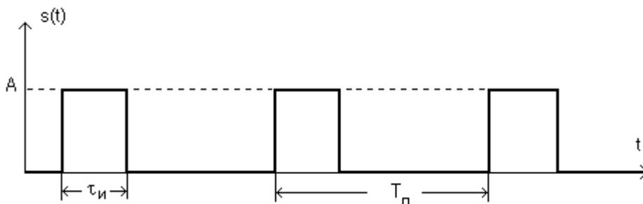
Рис. 1. 6. Осциллограмма бинарного сигнала.
