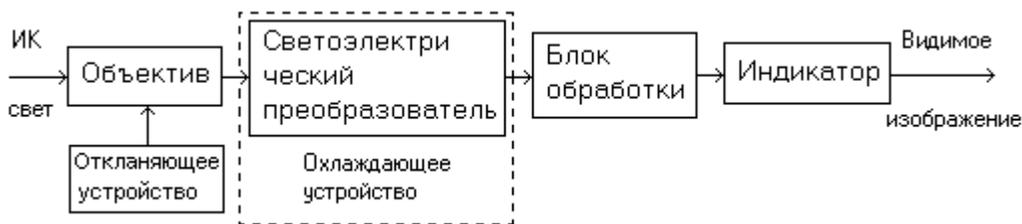
Рис. 3.3. Схема тепловизора.
