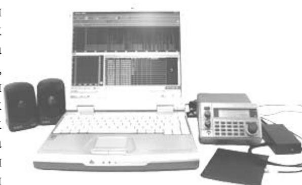
радиопередатчики с любыми видами модуляции и кодирования, функционирующие на частотах до 2600 МГц. Время сканирования всего диапазона частот составляет 1,5 - 3 минуты. С помощью конвертера RS1000/L комплекс обнаруживает сигналы, которые
