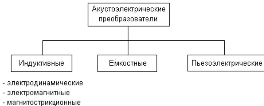
Рис. 1.10. Классификация акустоэлектрических преобразователей.
