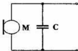
Рисунок 5.2- Схема защиты микрофона телефонного аппарата
