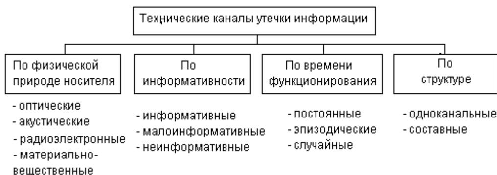
Рис. 4.2. Классификация каналов утечки информации.
