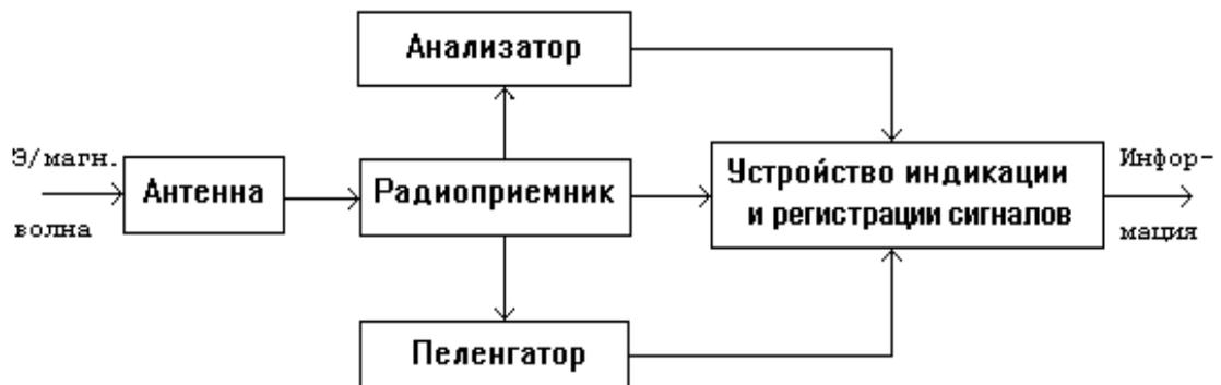
Рис. 3.8. Структура комплекса средств перехвата.
