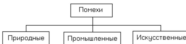
Рис. 4.5. Классификация помех в каналах утечки.
