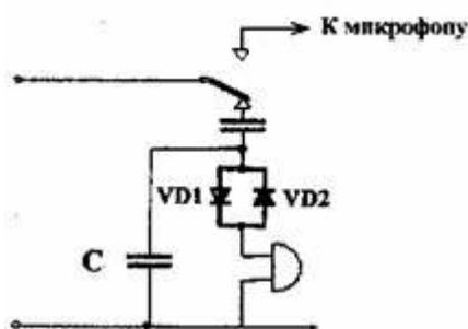
Рисунок 5.1 - Схема защиты звонковой цепи
