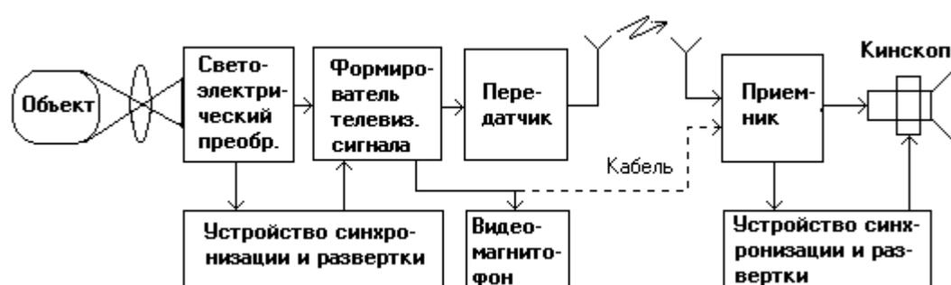
Рис. 3.4. Схема средств телевизионного наблюдения.
