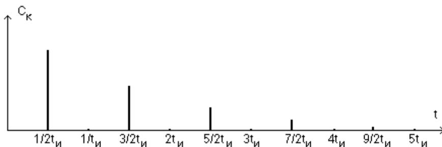
Рис. 1.7. Спектр бинарного сигнала.
