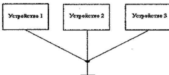
Рисунок 5.6 - Одноточечная параллельная схема заземления
