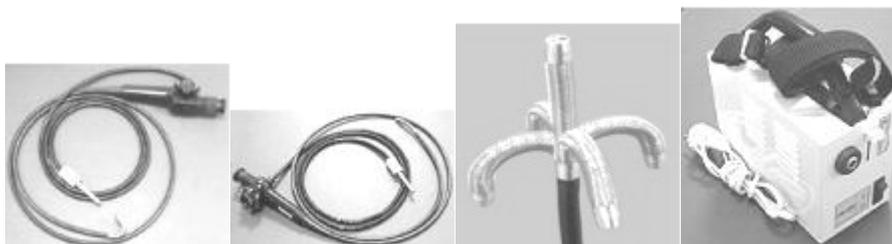
Используются для визуального контроля труднодоступных мест, в том числе закрытых, светоизолированных, имеющих малые входные отверстия путем визуального осмотра.
