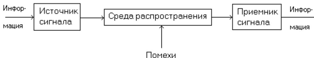
Рис. 4.4. Структура радиоэлектронного канала утечки информации.
