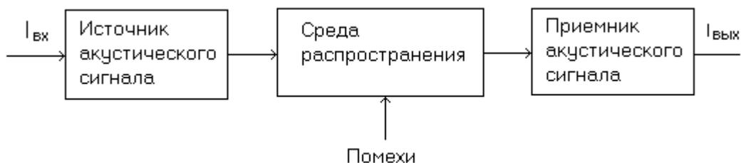
Рис. 4.6. Структура акустического канала утечки информации.
