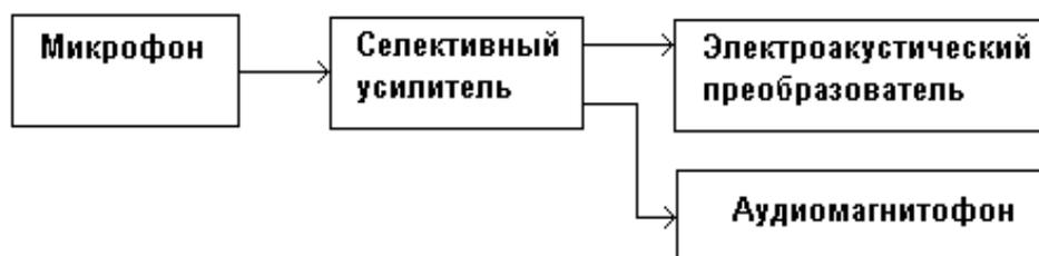
Рис. 3.12. Структурная схема акустического приемника.
