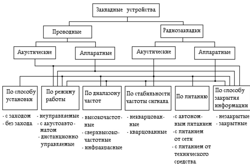
Рис. 3.14. Классификации закладных устройств.
