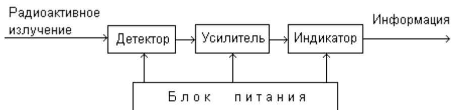
Рис. 3.16. Структура прибора радиационной разведки.
