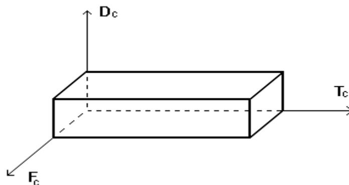
Рис. 1.9. Графическое представление объема сигнала.
