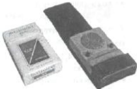
Защищает от средств съема информации (микрофоны, радиомикрофоны, цифровые и пленочные диктофоны, стетоскопы), излучая «белый» нефильтруемый звуковой шум. Благодаря использованию цифровых технологий генератор излучает шум в таком диапазоне, который точно соответствует входному диапазону диктофонов и микрофонов (250-4500 Гц). Поэтому Skeller создает эффективную помеху и мешает разговору значительно
