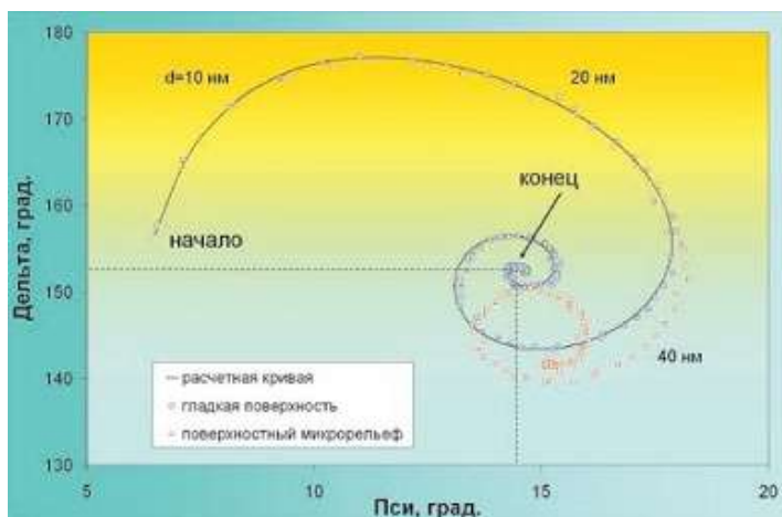
Рис. 2.11. Изменения эллипсометрических параметров, измеренные на начальной стадии роста пленки КРТ. Из сравнения эксперимента с расчетной кривой определяется скорость роста. Огрубление поверхности, вызванное неоптимальными условиями роста, приводит к смещению кривой в сторону меньших значений параметра \Delta
