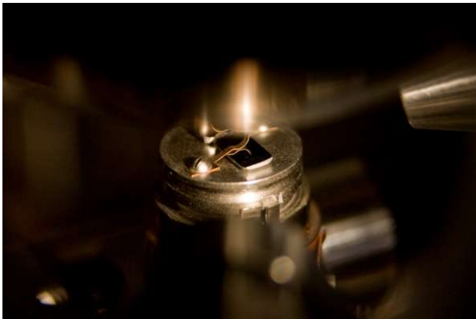
5.7. Исследуемый образец в электронном оже-спектрометре (съемка через смотровое окошко)
