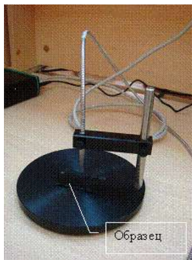
Рис. 1.9. Правильно установленный образец
