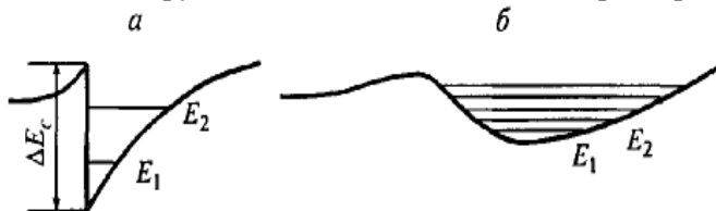
Рис. 2.1. Потенциальный профиль края зоны проводимости для резкого (а) и плавного (б) гетеропереходов
