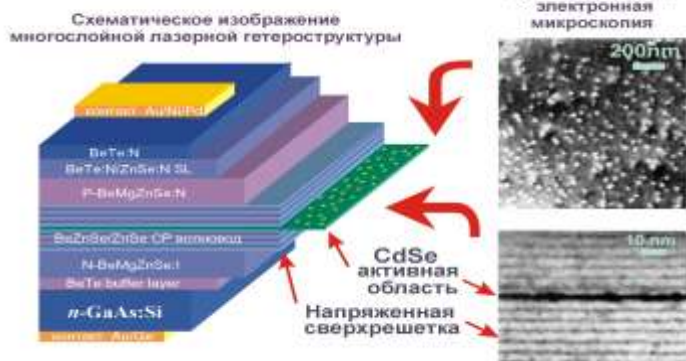
Рис. 1.15. Структурная схема и микрофотографии многослойной лазерной структуры на основе взаимодействия квантовых ям и квантовых точек
