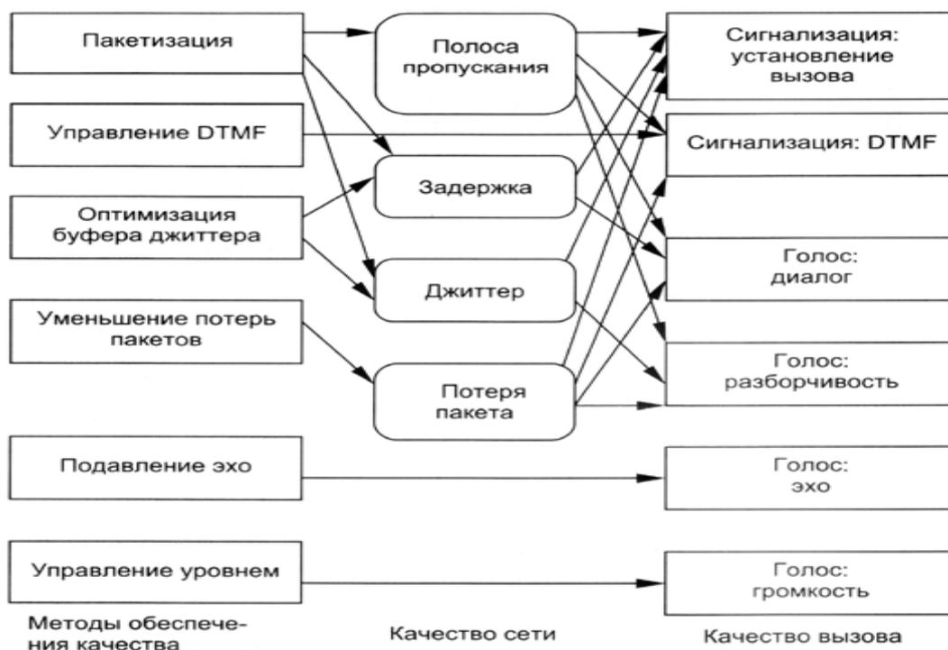
Рис. 5. Схема обеспечения качества IP-телефонии
