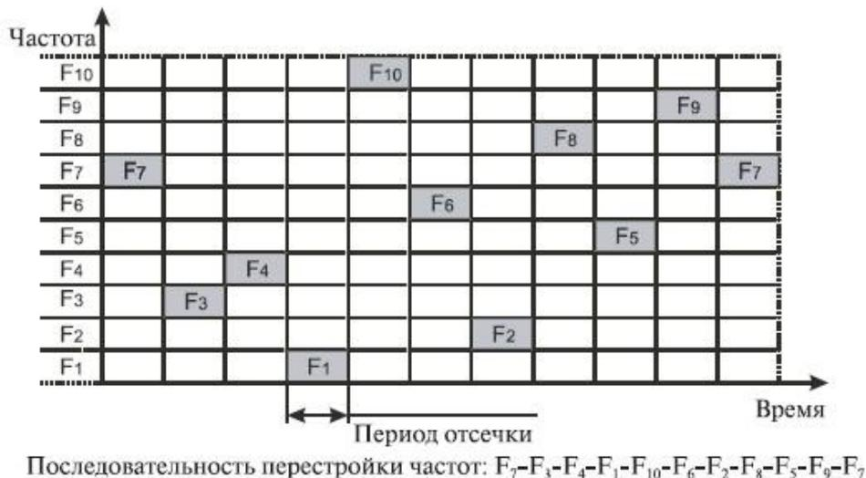
Рис. 1.4.3. Расширение спектра скачкообразной перестройкой частоты
