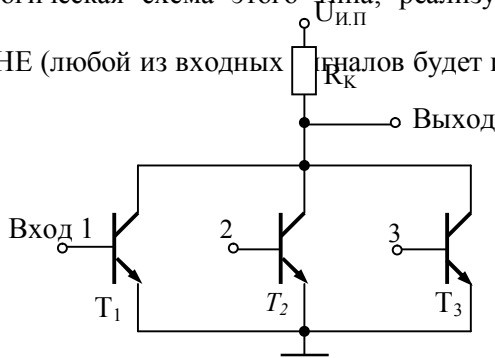
Рис. 8.1. Основная логическая схема ТЛНС
