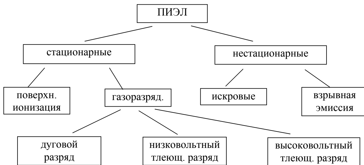
Рисунок 7.1 Классификация плазменных источников по способу получения плазмы
