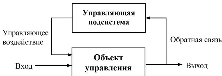
Рис. 1.9. Схема функционирования системы с управлением
