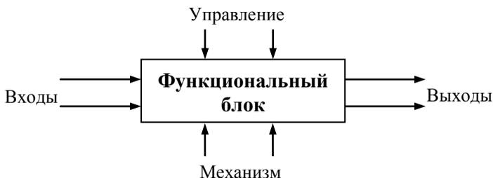
Рис. 3.9. Функциональный блок IDEF0-диаграммы
