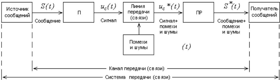
Рис. 1.1. Структурная схема системы передачи сигналов электросвязи
