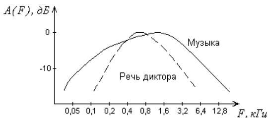
Рис. 10.7. Зависимости нормированной спектральной плотности мощности от частоты для речевых и музыкальных сигналов звукового вещания
