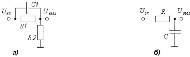
Рис. 10.3. Схемы ЦП передатчика (а) и ЦКП приемника (б)
