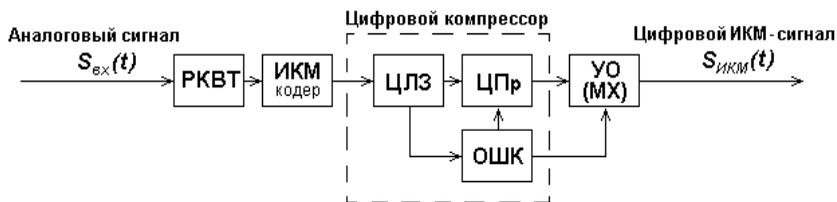
Рис. 11.14. Структурная схема кодера с адаптивным компрессором:
