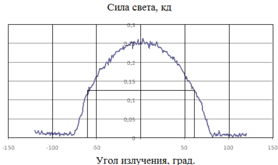
Рисунок 14. Зависимость значения силы света светодиода от угла его излучения – кривая распределения силы света
