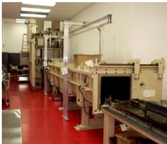
Рис. 2. Система подачи деталей и вакуумная камера установки электронно-дуговой сварки.
