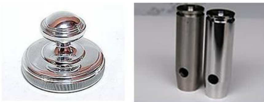
Рис. 4.10. Примеры электрохимического полирования стальных деталей.
