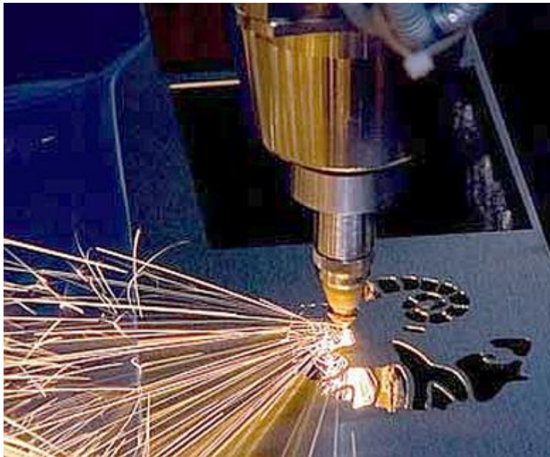
Рис.4.12. Высокотехнологичная обработка металлов: лазерная резка.
