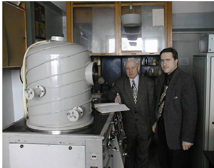
б) напылительная установка УВН-2М1
