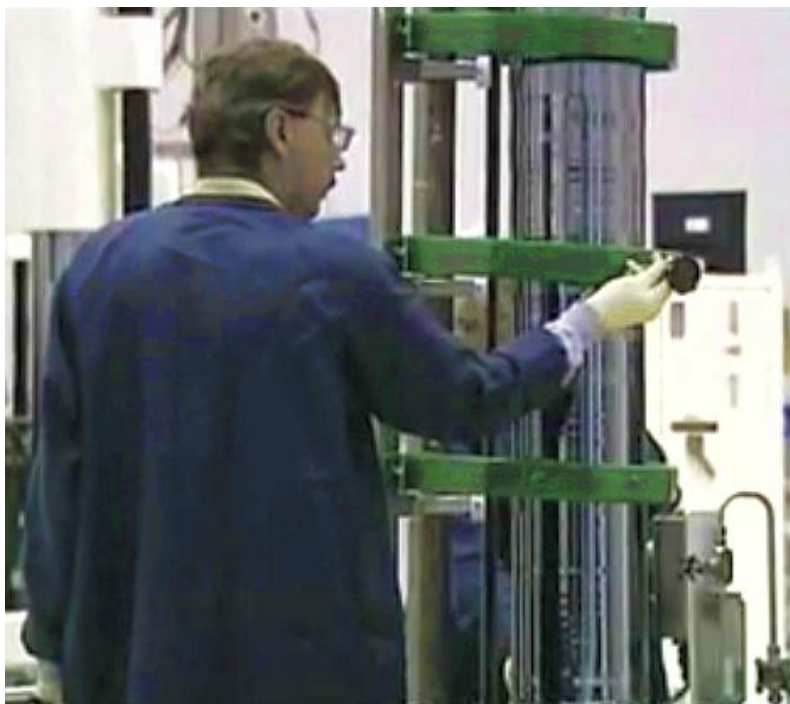
Рис.6.8. Метод Чохральского, спуск и извлечение выращенного кристалла
