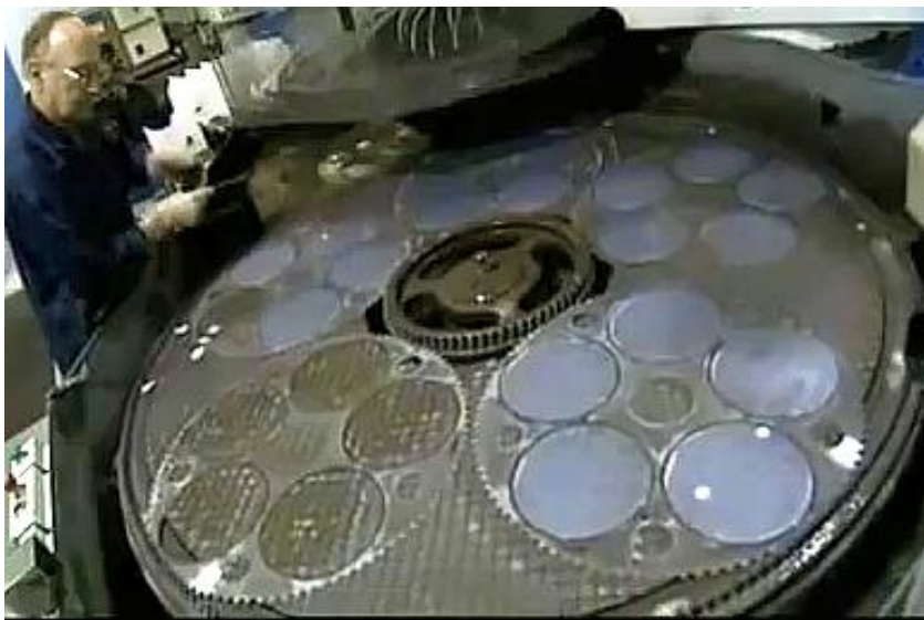
б) шлифовка пластин абразивными порошками
