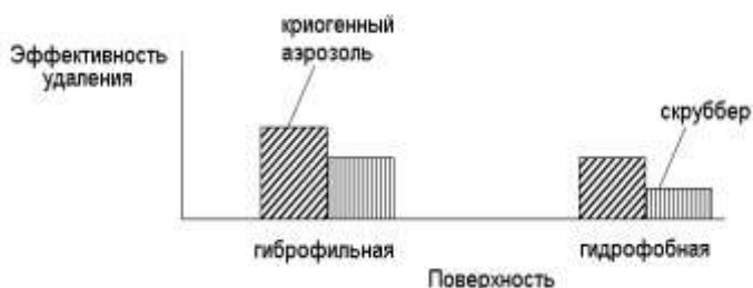
Рис. 4.4. Сравнение эффективности удаления частиц криогенным аэрозолем и стандартной жидкостной очисткой с помощью скруббера на гидрофобной (SiN, SiOC) и гидрофильной (SiO 2 ) поверхности
