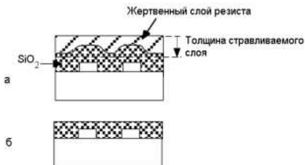
Рис. 10.2. Планаризация полупроводниковой структуры травлением жертвенного слоя резиста, нанесённого на рельефную поверхность: а – до планаризации; б – после планаризации
