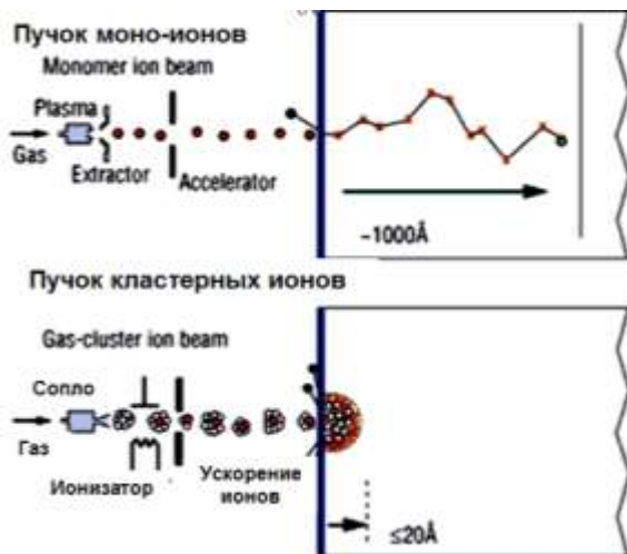
Рис. 6.8. Траектории моно- и кластерных ионов
