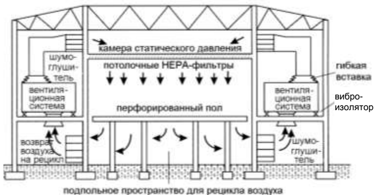
Рис. 3.1. Чистое помещение с вертикальным однонаправленным потоком воздуха
