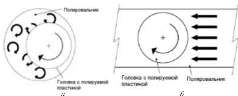
Рис. 10.8. Кинематические схемы движения головки с полируемой пластиной: а – орбитально-вращательное движение; б – возвратно-поступательное движение
