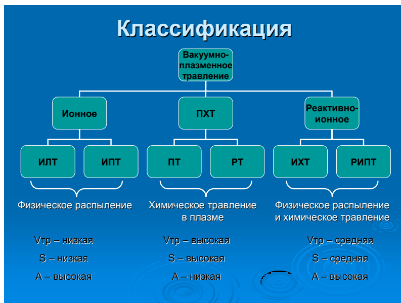
Рис. 8.1. Классификация методов травления
