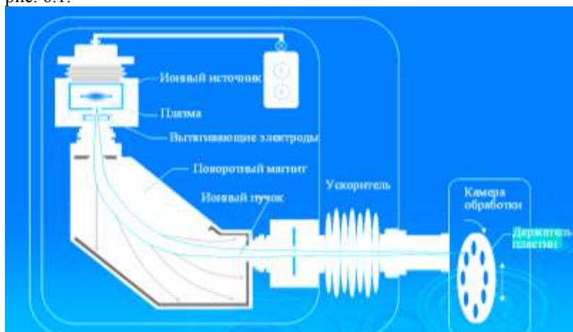
Рис. 6.1. Схема установки ионной имплантации
