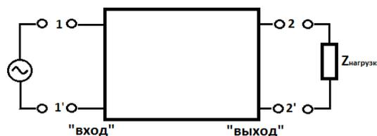
Рис.1.2. Обозначение зажимов четырехполюсника
