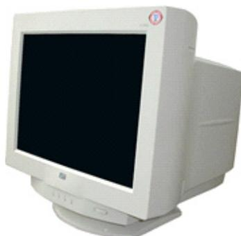
Рис. 3.27 – ЭЛТ-монитор
