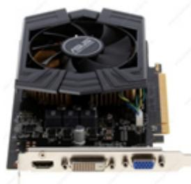
Рис. 3.25 – Разъёмы видеокарты Asus GeForce GT 740
