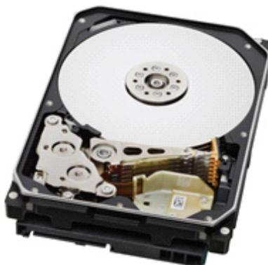
Рис. 3.18 – Накопитель на жёстких магнитных дисках («винчестер»)
