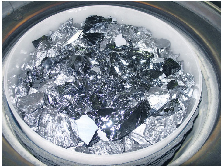
Кварцевый тигель, заполненный дроблёным кремнием
