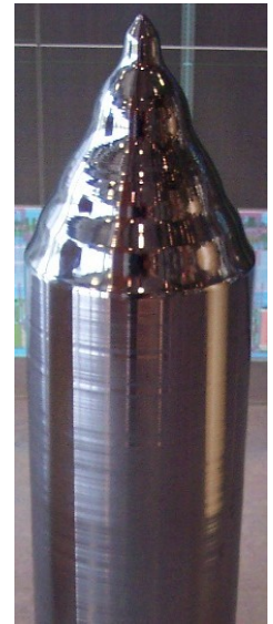
Монокристалл кремния, выращенный методом Чохральского
