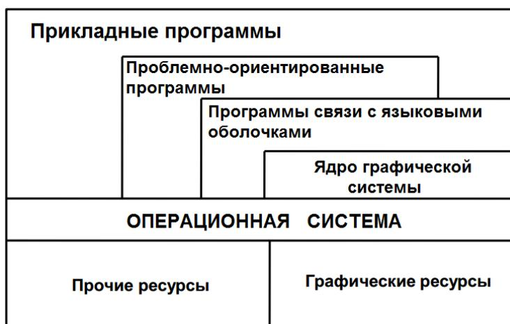
Рис. 1.3 – Модель функционирования ядра графической системы
