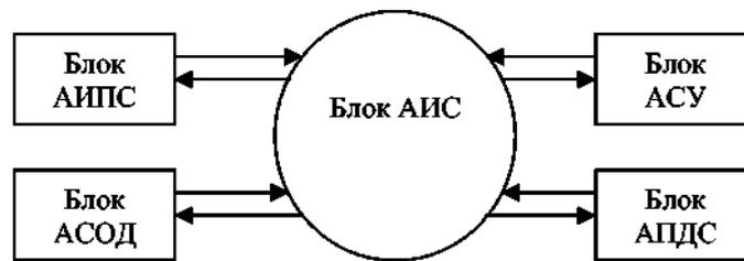
Рисунок 1.1 - Структура АИС мониторинга
