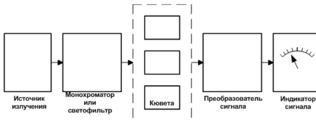
Рисунок 5.3 - Основные узлы абсорбционных приборов
