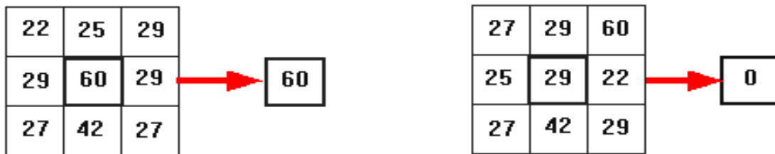
Рис. 3. – Работа экстремального фильтра
