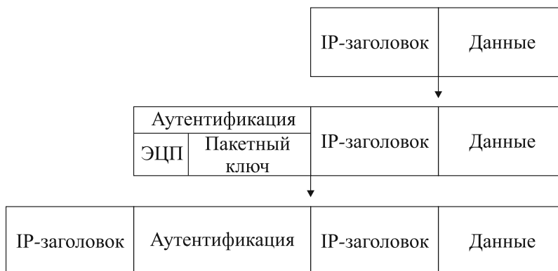
Рис. 4.17 – Инкапсуляция пакета VPN
