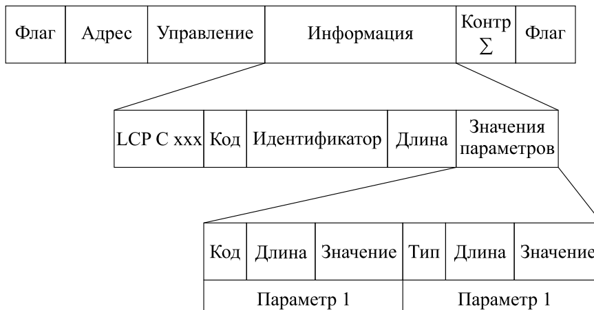
Рис. 3.5 – Передача информации о параметрах канала в сессии LCP
