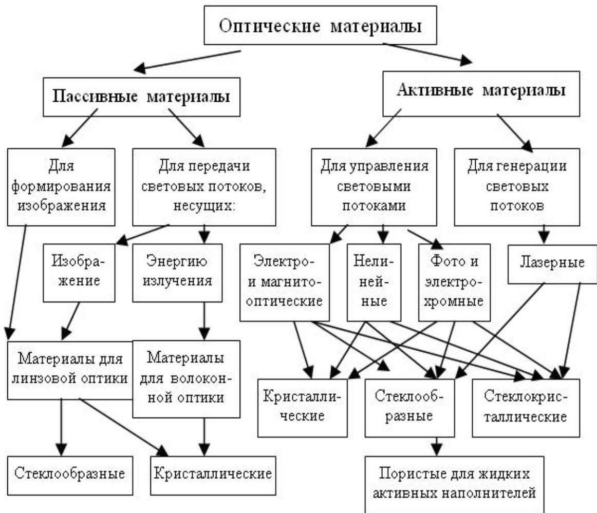
Рис.1. Общая схема взаимосвязей между различными группами оптических материалов.
