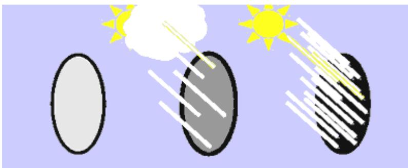
Рис. 6.1. Фотохромные свойства: а) неактивированное состояние, б) при слабой освещенности, в) при сильной освещенности
