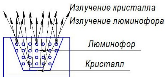
Рисунок 7. Процесс формирования излучения СД с кристаллом синего свечения и люминофором
