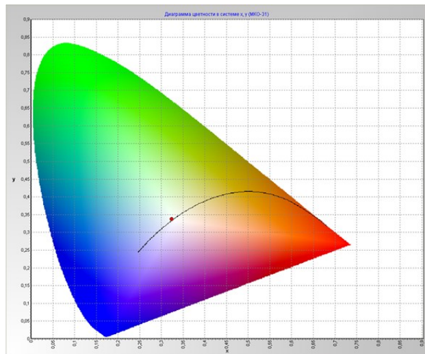
Рисунок 6. А – Относительная чувствительность глаза и спектр излучения типового белого светодиода, Б – диаграмма цветности в системе x, y (МКО-31)
