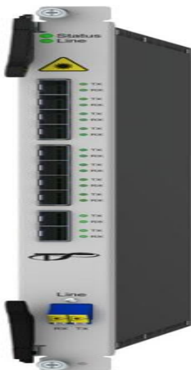
Рис. 2.48 — Внешний вид транспондера MS-100E-T10 [35]
