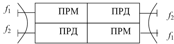
Рис. 8.3 – Структурная схема дуплексной промежуточной радиорелейной станции
