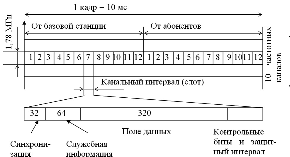
Рис. 9.9 – Структура каналов и сигнала стандарта DECT
