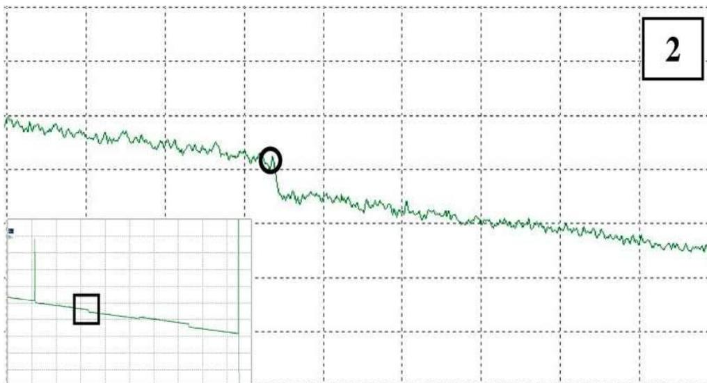
Рис. 4.22. Неоднородность без отражения (сварное соединение, изгиб волокна (радиус меньше допустимого) - ступенька вниз)
