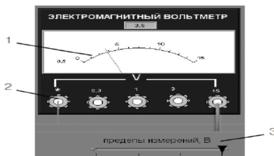
Рис. 5.5. Внешний вид модели электромагнитного вольтметра
