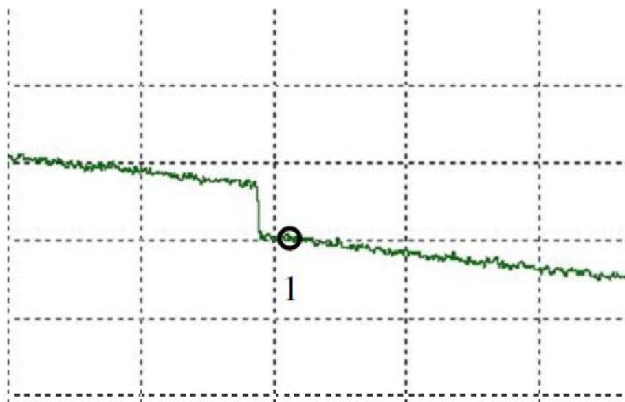
Рис. 4.50. Мертвая зона относительно неоднородности без отражения
