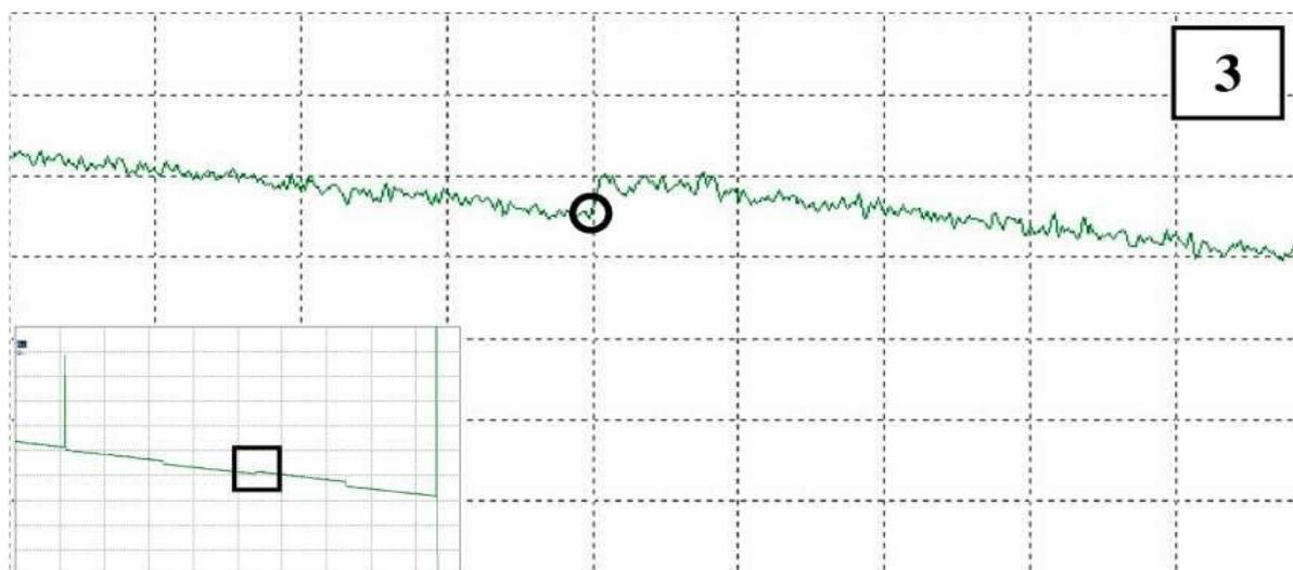
Рис. 4.23. неоднородность без отражения (сварное соединение - ступенька вверх)
