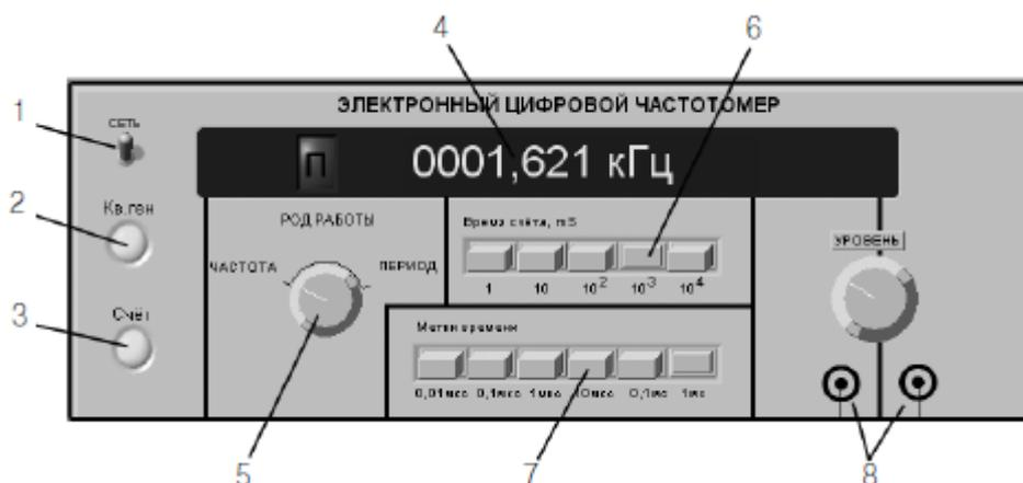
Рис. 5.15. Внешний вид модели электронного цифрового частотомера
