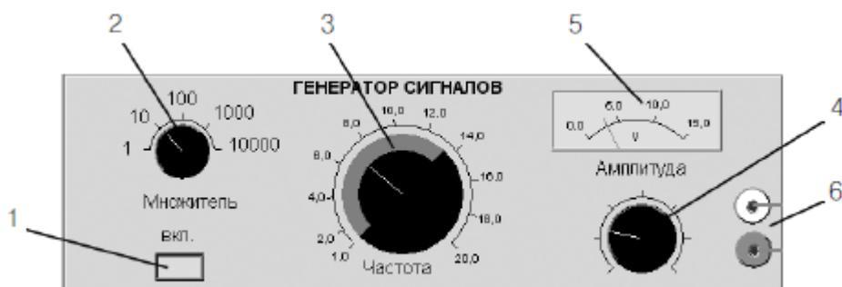
Рис. 5.17. Внешний вид модели генератора сигналов синусоидальной формы
