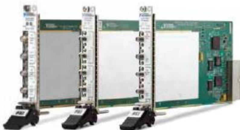
Рис. 5.33. ВЧ-предусилители и аттенюаторы
