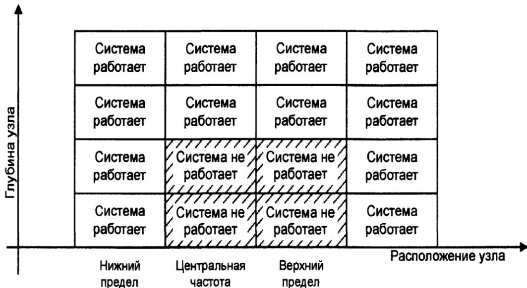
Рис. 2.39. Матрица функционирования при проведении стрессовых измерений
