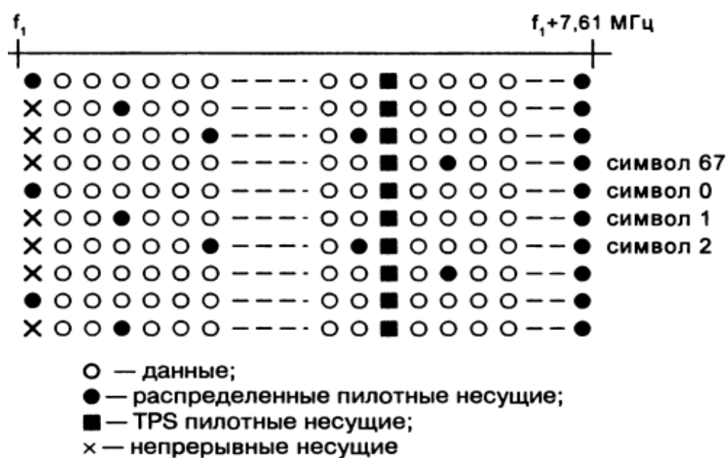
Рис. 4.14. Структурная схема формирователя OFDM-символа в системе DVB-T
