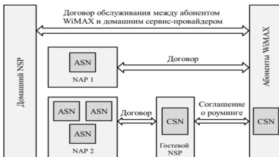
Рис. 3.76. Модель взаимодействия операторов сервисных сетей WiMAX IEEE 802.16, сетей доступа и абонентов
