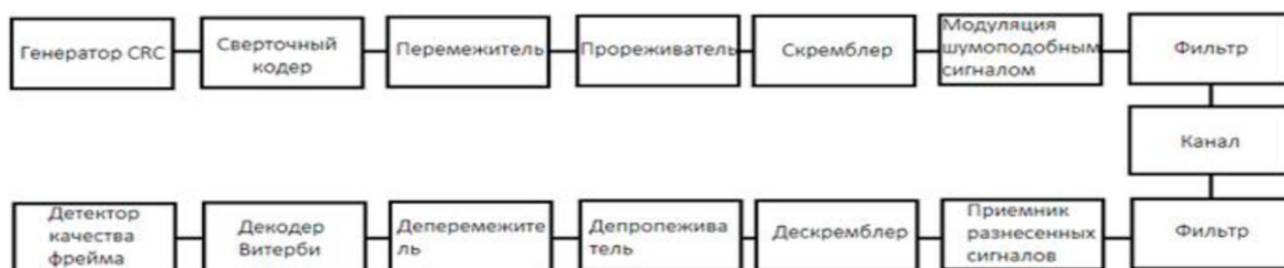
Рис. 3.18. Структурная схема CDMA
