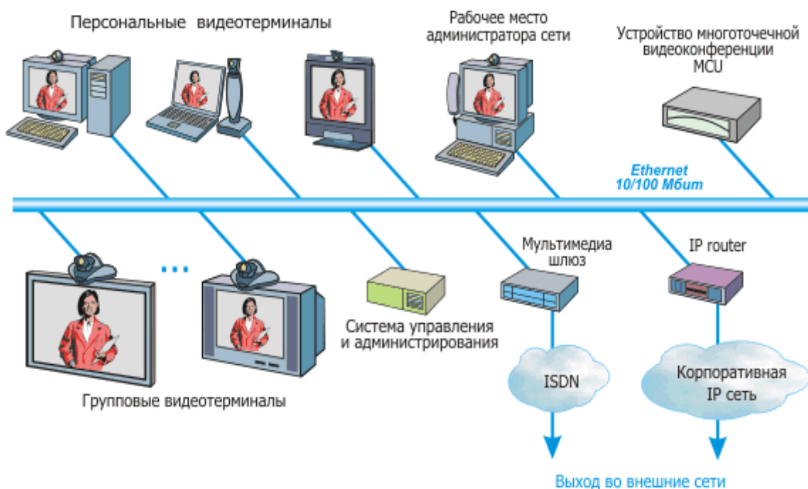
Рис. 2.109. Структурная схема многоточечной видеоконференции в локальной сети.
