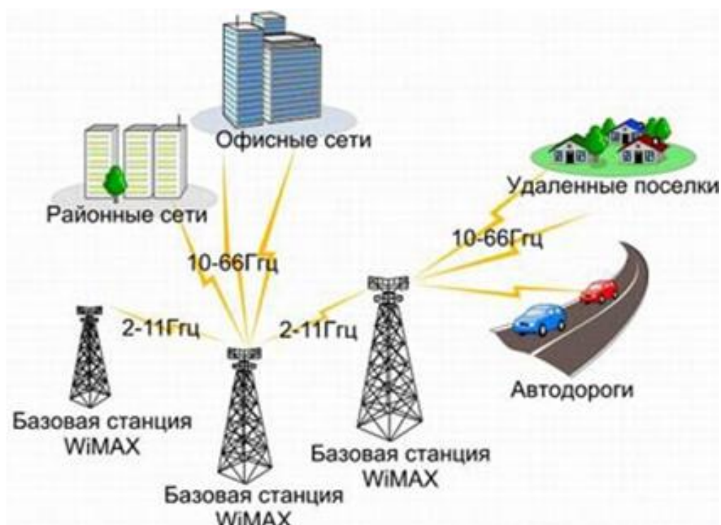
Рис. 3.71. Схематическое изображение сети WiMAX
