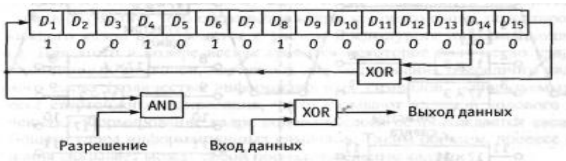
Рис. 4.4. Структурная схема устройства рандомизации данных
