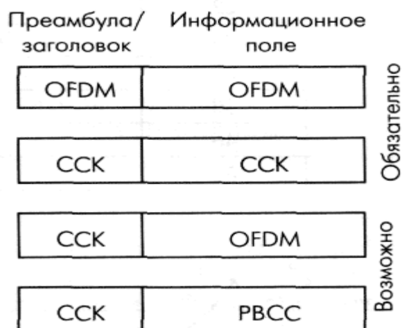
Рис. 3.56. Кадры IEEE 802.11g в различных режимах модуляции
