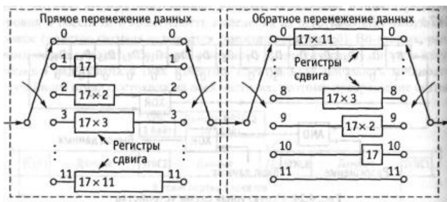
Рис. 4.6. Функциональная схема внутреннего перемежителя данных
