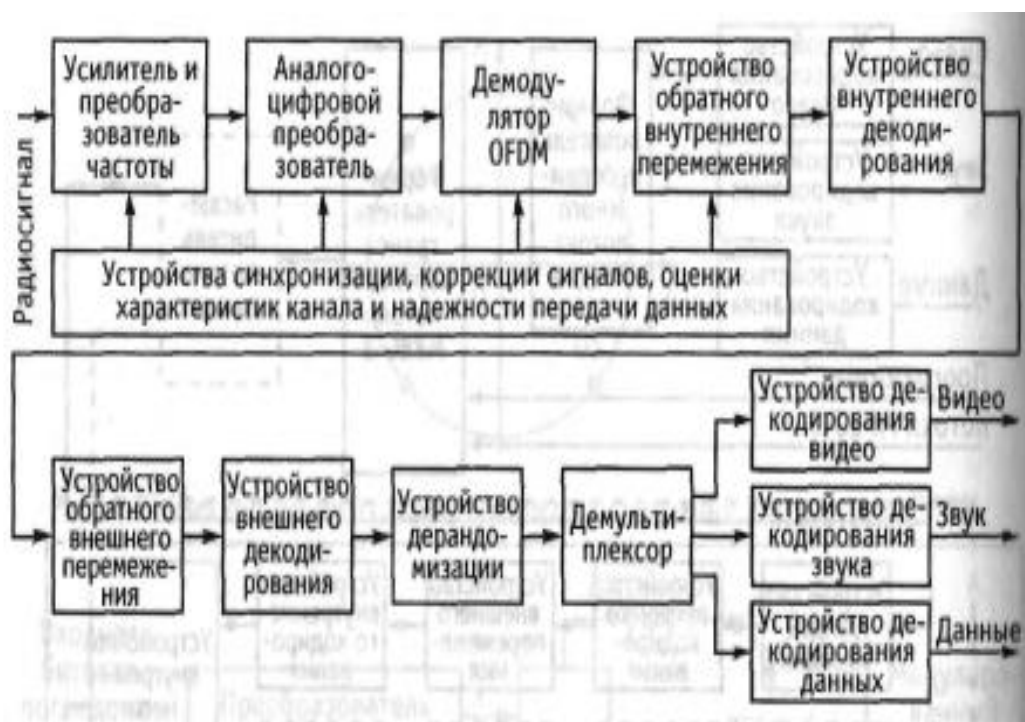
Рис. 4.2. Структурная схема приемника системы DVB-T
