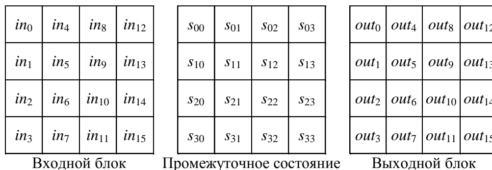
Рис. 2.34. Входной и выходной блоки данных, промежуточное состояние
