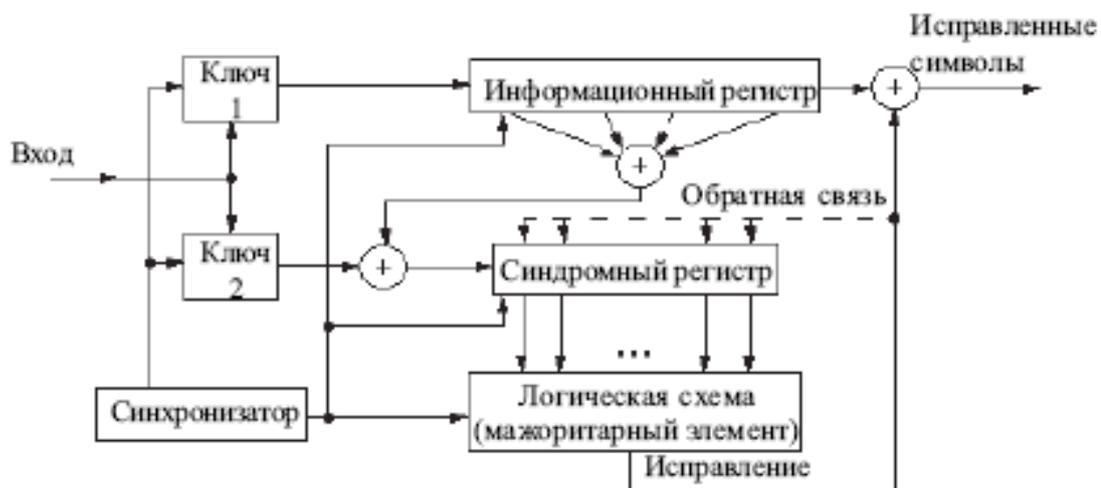
Рис. 6. Функциональная схема декодера Витерби
