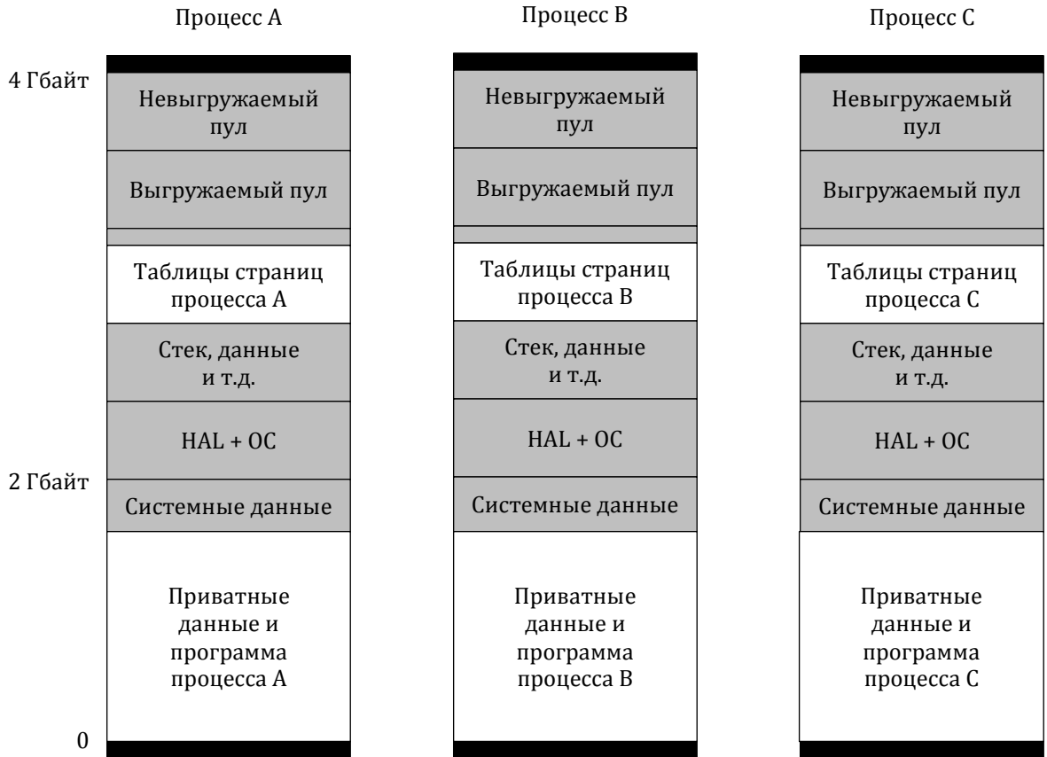
Рисунок 12.2 – Конфигурация виртуального адресного пространства для трех пользовательских процессов
