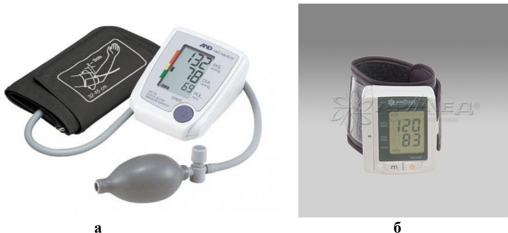
Рис. 1.2. Прибор для измерения артериального давления: полуавтоматический (а) и автоматический (б)
