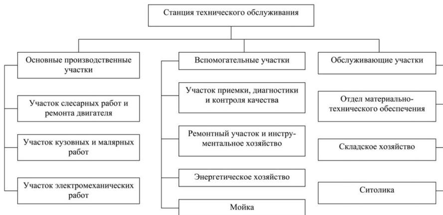
Рис. 2.7. Примерная производственная структура предприятия по ремонту и обслуживанию автомобилей
