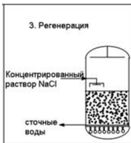
Рисунок 2.9 – Регенерация установки ионного обмена
