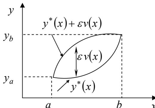
Рис. 3.1 Функция  $y(x)$  и ее вариация  $\varepsilon v(x)$  для задачи с закрепленными концами
