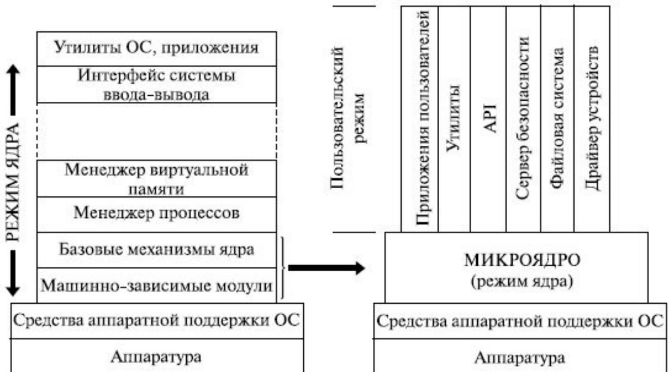
Рисунок 1.7 - Сравнение классической и микроядерной архитектур ОС
