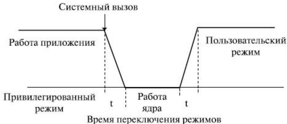
Рисунок 1.6 - Переключение режимов монолитного ядра ОС
