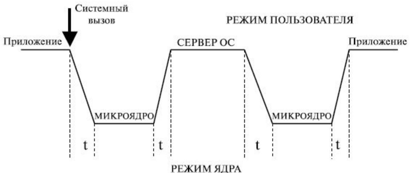
Рисунок 1.9 - Схема переключения режимов микроядерной архитектуры ОС
