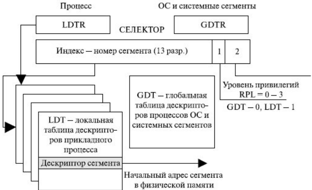
Рисунок 2.14 - Адресация памяти MS Windows на архитектуре i386
