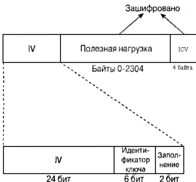
Рисунок 4.21. Фрейм, зашифрованный алгоритмом WEP
