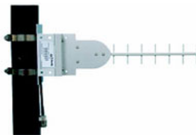
Рисунок 4.43. Направленная внешняя антенна ANT24-1201
