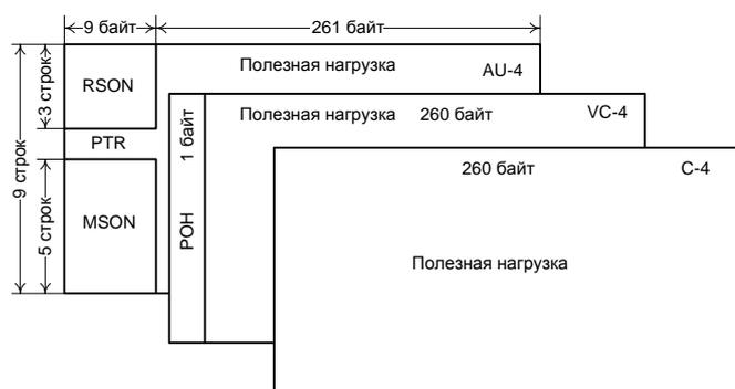
Рис. 1.2 – Структура модуля STM-1
