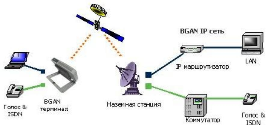
Рис.6.3. Структурная схема сети Inmarsat BGAN
