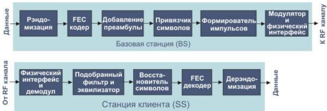
Рис. 9.7. Блок-схема подуровня PMD нисходящего канала
