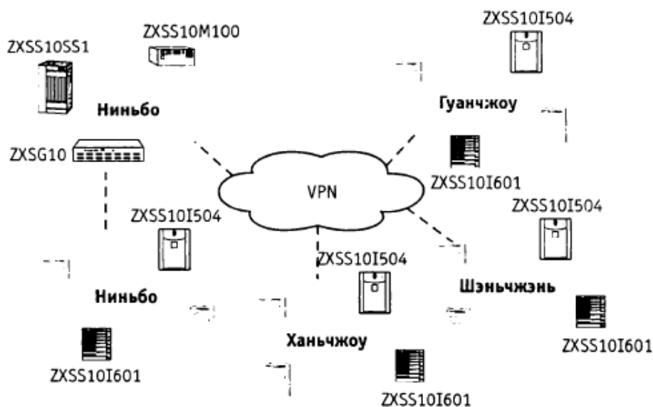
Рис. 5.18. Взаимодействие широкополосных речевых услуг, предоставляемых системой Softswitch от ZTE, в нескольких городских сетях
