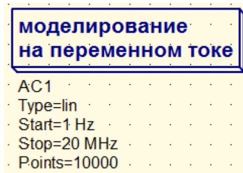
Рис. 10 – Кубик моделирования на переменном токе
