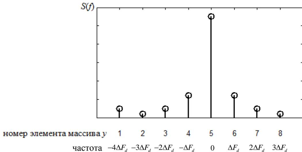
Рис. 1.8 Массив спектральных амплитуд после применения функции `fftshift`
