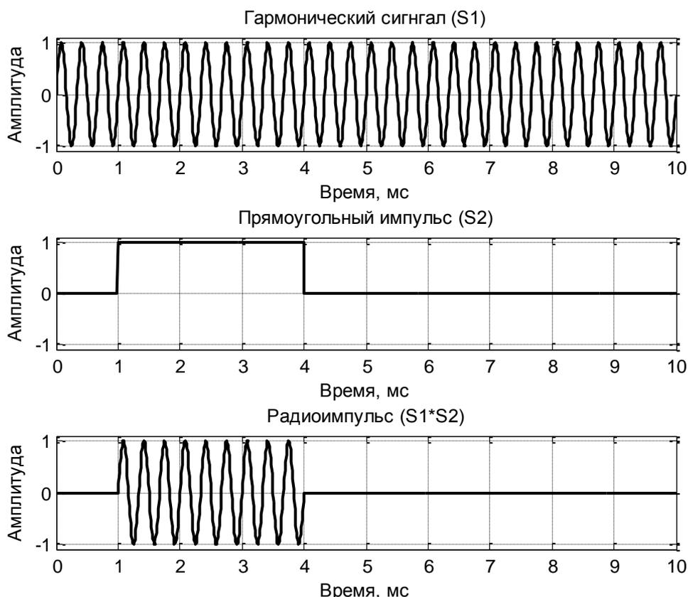
Рис. 3.1 – Способ формирования прямоугольного радиоимпульса
