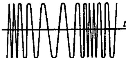
Рис. 4.2 – Осциллограмма типичного сигнала с частотной модуляцией [4]
