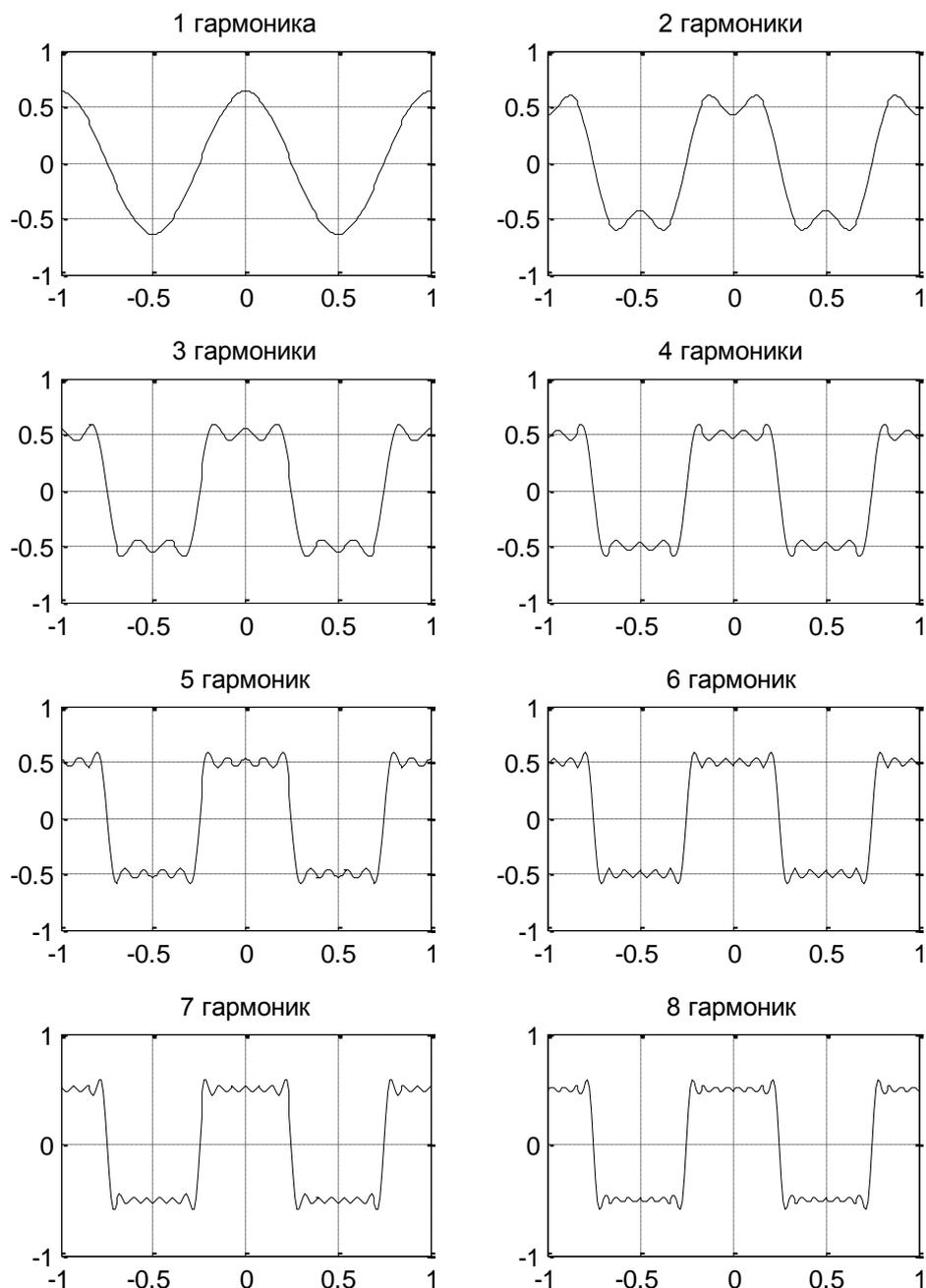
Рис. 1.4 Аппроксимация прямоугольного сигнала суммой нескольких синусоидальных колебаний (гармоник)
