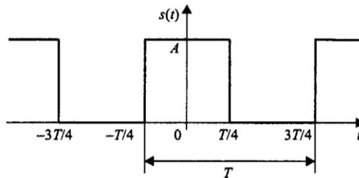
Рис. 1.3 Последовательность прямоугольных импульсов [1]
