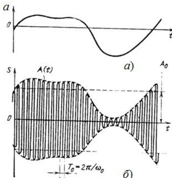
Рис. 4.1 – Модулирующая функция (а) и амплитудно-модулированное колебание (б) [4]
