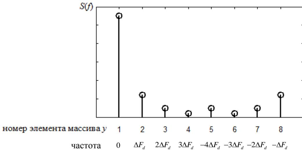
Рис. 1.7 Массив амплитуд на выходе функции `fft` при  $N = 8$
