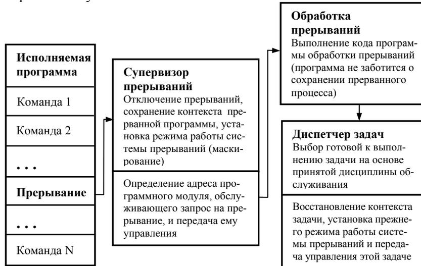
Рис. 1.4 – Обработка прерываний при участии супервизоров ОС
