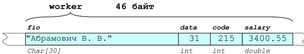
Рис. 47. Размещение переменной *worker* структурного типа в памяти
