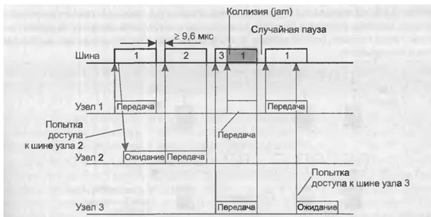
Рис. 6.2 — Метод случайного доступа CSMA/CD.
