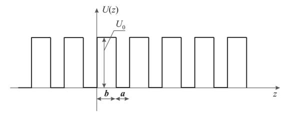
Рис. 3.1 – Рельеф потенциала электрона в кристалле в модели Кронига – Пенни
