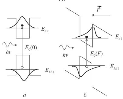
Рис. 6.5 — Энергетические диаграммы гетероструктуры с КЯ: a — в отсутствие электрического поля,  $\delta$  — в электрическом поле с напряженностью F
