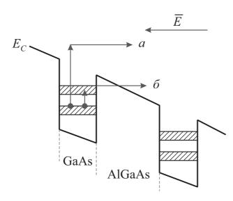
Рис. 7.13 – Энергетическая диаграмма, иллюстрирующая принцип работы ИК-приемника на основе гетероструктур с квантовыми ямами
