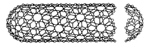
Рис. 7.24 – Идеализированная модель однослойной нанотрубки [104]
