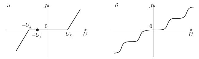
Рис. 6.17 – Вольт-амперные характеристики элемента, работающего на основе эффекта кулоновской блокады
