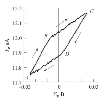
Рис. 7.6 – Гистерезис в зависимости тока электрометра при различных направлениях изменения напряжения  $V_3$  на затворе ячейки памяти
