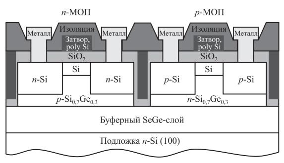
Рис. 7.19 – Структура SiGe КМОП-ячейки ИС
