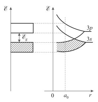
Рис. 2.11 – Образование запрещенной зоны и разрешенной зоны в кристаллах с кристаллической решеткой типа алмаза
