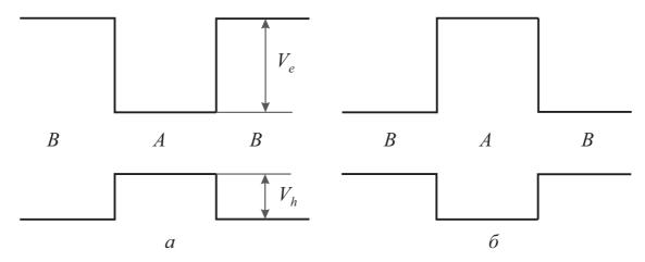
Рис. 4.4 — Зонная схема двойного гетероперехода первого рода с квантовой ямой a или барьером  $\delta$ ;  $V_{e,h}$  — высота потенциального барьера (глубина квантовой ямы) или разрыв зон на интерфейсе в зоне проводимости и валентной зоне соответственно [76]
