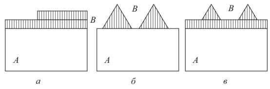
Рис. 5.2 — Схемы трех типов начальной стадии гетероэпитаксиального роста. Материал B осаждается на подложку A
