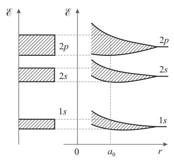
Рис. 2.10 – Схема расщепления уровней при образовании кристалла
