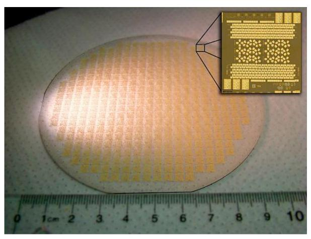
Рис. 8.3 — 100-мм пластина графена, содержащая приблизительно 75 000 устройств и тестовых структур. На вставке — оптическое изображение одного чипа. Каждый маленький квадрат на чипе составляет всего 100 мкм — толщина человеческого волоса. Устройства были изготовлены на Penn State Nanofab, учреждение Научно-исследовательского института материалов (фото: Джошуа Робинсон) [113]
