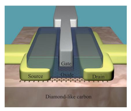
Рис. 8.6 – Принципиальная схема графенового транзистора на алмазоподобной подложке (фото: P. Avouris) [117]
