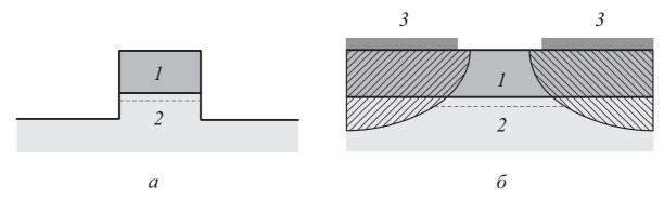
Рис. 5.5 — Полупроводниковые гетероструктуры с квантовыми нитями, полученные с помощью субмикронной литографии за счет вытравливания узкой полоски из самой структуры (a) или щели в затворе Шоттки ( $\delta$ ):
