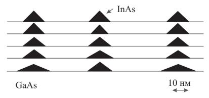
Рис. 5.4 – Схематическое изображение связанных массивов квантовых точек
