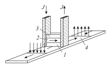
Рис. 6.20 – Схематическое изображение ГМС-головки на магнитной ленте
