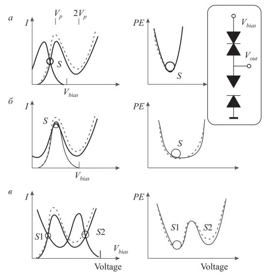
Рис. 7.12 — Нагрузочные кривые и соответствующие диаграммы потенциальной энергии для базового элемента, обеспечивающего переход из моностабильного в бистабильное состояние
