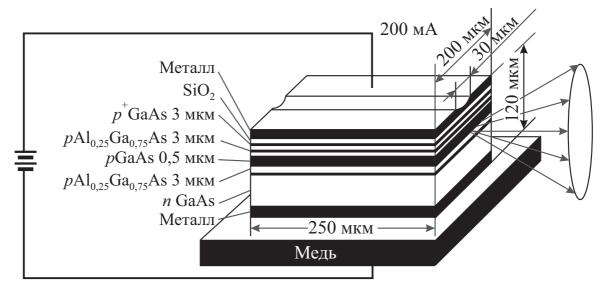
Рис. 7.14 – Схематическое изображение структуры первого инжекционного ДГС лазера, работающего в непрерывном режиме при комнатной температуре [69]
