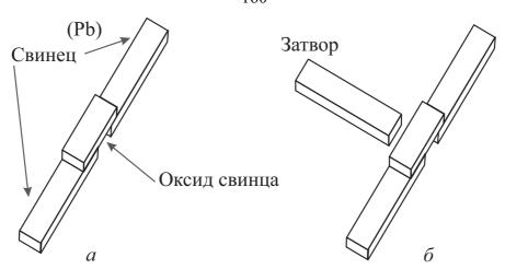
Рис. 6.11 - a) джозефсоновский переход, б) транзистор на эффекте Джозефсона
