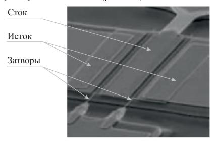
Рис. 7.23 — «Двухпальцевый»  $Al_xIn_{1-x}Sb/InSb$  МНЕМТ-транзистор с 0,1-мкм затвором
