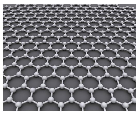
Рис. 8.2 – Графен представляет собой гексагональную решетку из атомов углерода толщиной в один атом
