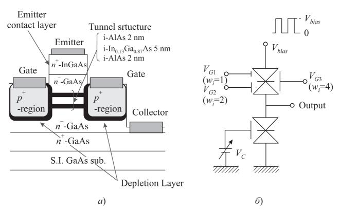
Рис. 7.10 - a) схематическая структура РТТ, имеющего затвор в виде  $p^+$ -n-перехода;  $\delta$ ) конфигурация схемы трехвходового устройства MOBILE
