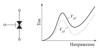
Рис. 7.8 – Условное обозначение резонансно-туннельного транзистора в электрических схемах и его вольт-амперные характеристики
