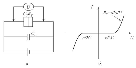
Рис. 6.14 — Эквивалентная схема (*a*) и вольт-амперная характеристика однобарьерной структуры (*б*)
