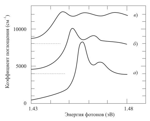
Рис. 6.7 — Спектры поглощения многоямной структуры GaAs/AlGaAs при различных значениях электрического поля F в i-области: a) F = 10 кВ/см, b0 F = 47 кВ/см, b0 F = 73 кВ/см
