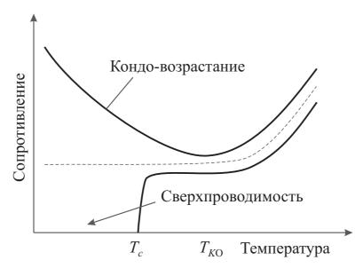
Рис. 6.21 – Типы температурных зависимостей сопротивления металлов в области низких температур (0–10 K)
