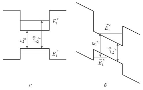
Рис. 7.17 — Энергетический спектр квантовой ямы в отсутствие (a) и при наличии ( $\delta$ ) приложенного электрического поля
