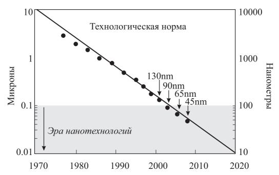
Рис. 1.2 – Динамика уменьшения размеров элементов микросхемы. Переход от микро- к нанотехнологиям, начиная со 100 нм в 2003 г.
