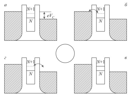
Рис. 7.4 – Схема прохождения одного электрона через квантовую точку при периодической модуляции высоты туннельных барьеров [78]
