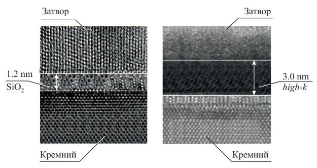
Рис. 1.4 — Структура полевого транзистора с разным подзатворным диэлектриком: диоксид кремния  $SiO_2$  (слева) и оксид гафния  $HfO_2$  (справа)
