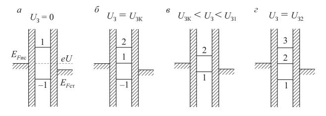
Рис. 7.2 – Энергетические диаграммы, поясняющие работу транзистора, схема которого представлена на рисунке 7.1
