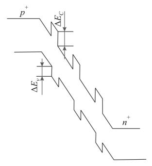
Рис. 7.16 – Схема лавинного фотодиода с системой квантовых ям
