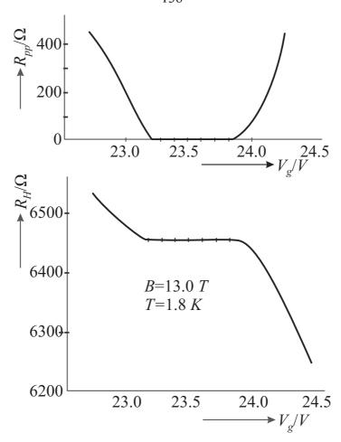
Рис. 6.2 — Сопротивление Холла  $R_H$  и сопротивление прибора  $R_{pp}$  между потенциальными зондами в зависимости от напряжения на затворе  $V_g$ , величине которого соответствуют полностью занятые минимальные (n=0) состояния уровня Ландау. Плато  $R_H$  имеет значение  $6453,3\pm0.1$  Ом. Геометрия прибора L=400 мкм; W=50 мкм; расстояние между зондами  $L_{pp}=130$  мкм, B=13 Тл
