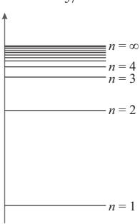
Рис. 2.5 – Энергетический спектр разрешенных состояний
