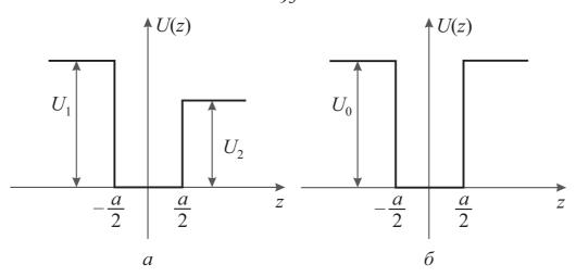
Рис. 3.3 – Потенциальный рельеф прямоугольной потенциальной ямы: a) несимметричной;  $\delta$ ) симметричной
