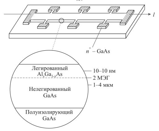
Рис. 6.3 – Типичные форма и сечение гетероструктуры  $Al_xGa_{1-x}As$ , используемой при измерениях эффекта Холла
