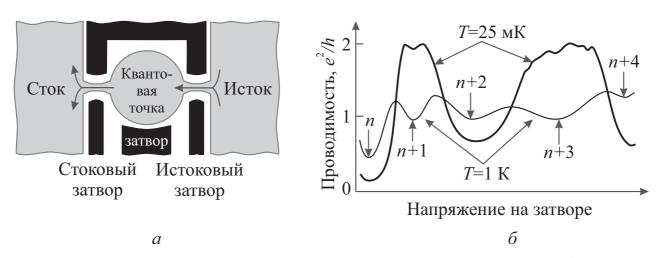
Рис. 6.22 – Управляемая квантовая точка (*a*) и ее проводимость как функция напряжения на затворе при двух различных низких температурах (*б*). n – четное число
