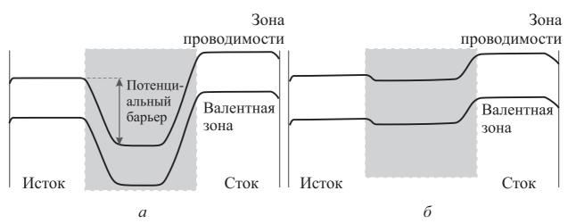
Рис. 7.26 — Зонные диаграммы транзистора без внешнего электрического поля (*a*) и в его присутствии (*б*)
