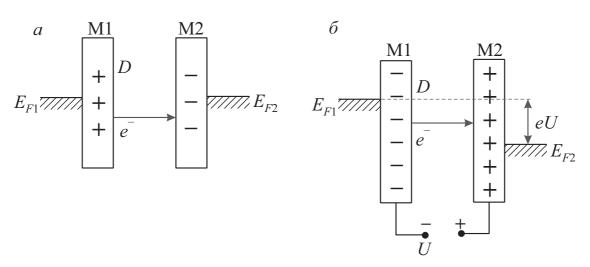
Рис. 6.13 – Схема, поясняющая механизм кулоновской блокады при туннелировании электронов
