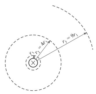
Рис. 2.4 – Радиусы разрешенных орбит в атоме водорода
