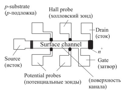
Рис. 6.1 – Схематичная диаграмма типичного для [79] МОП-транзистора
