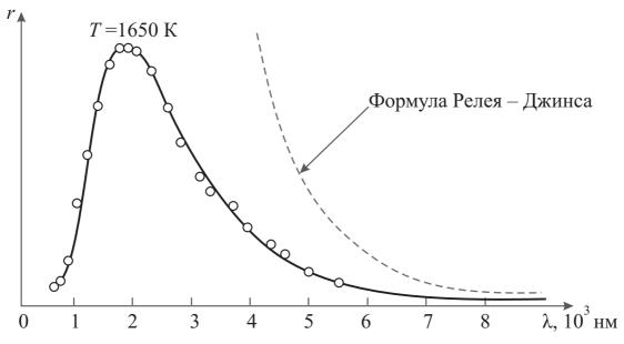
Рис. 2.2 — Сравнение экспериментального распределения  $r(\lambda,T)$  с законом Релея — Джинса
