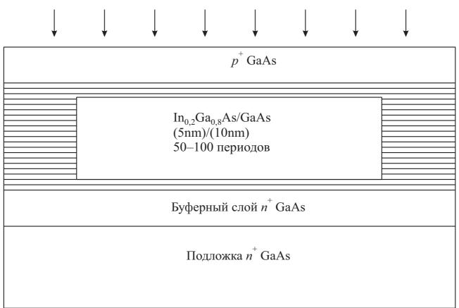
Рис. 6.6 — Схема многоямной гетеронаноструктуры InGaAs/GaAs, встроенной в  $p^+$ -i- $n^+$ -диод
