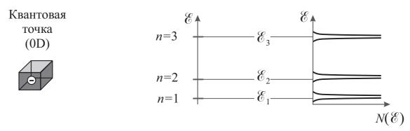
Рис. 3.7 — Нульмерная низкоразмерная структура, ее энергетическая диаграмма и плотность состояний  $N(\mathscr{E})$
