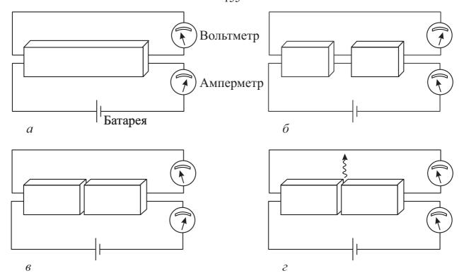
Рис. 6.9 – Токи и напряжения в системе сверхроводящих брусков
