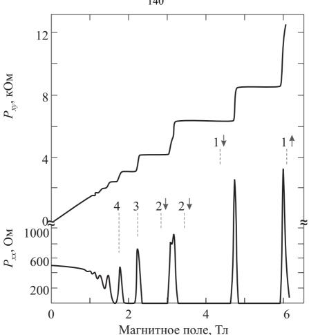
Рис. 6.4 — Экспериментальные зависимости холловского сопротивления  $R_H = \rho_{xy}$  и удельного сопротивления  $\rho_{xx} \sim R_x$  гетероструктуры от магнитного поля при фиксированной плотности носителей, соответствующей напряжению на затворе  $V_g = 0$ . Температура около 8 мК
