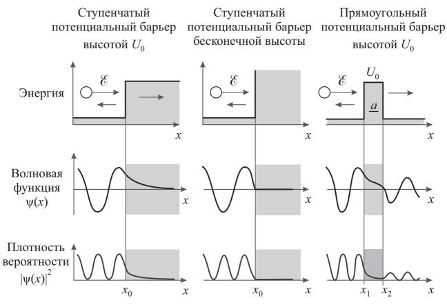
Рис. 3.8 — Взаимодействие квантовой частицы с полной энергией  $\mathscr E$  со ступенчатым барьером конечной высоты  $U_0$ , с бесконечно высоким потенциальным барьером и с прямоугольным барьером высотой  $U_0$  и шириной a
