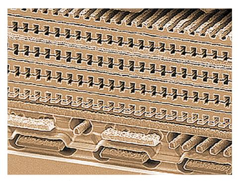
Рис. 1.5 – Кристалл Matrix 3D Memory содержит четыре слоя транзисторов
