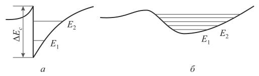
Рис. 5.1 — Потенциальный профиль края зоны проводимости для резкого (*a*) и плавного (*б*) гетеропереходов
