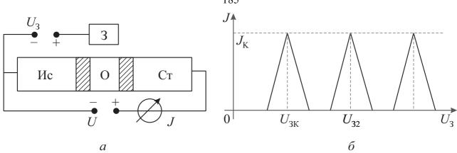
Рис. 7.1 - a) принципиальная схема транзистора, работающего на эффекте кулоновской блокады;  $\delta$ ) зависимость тока от напряжения на затворе
