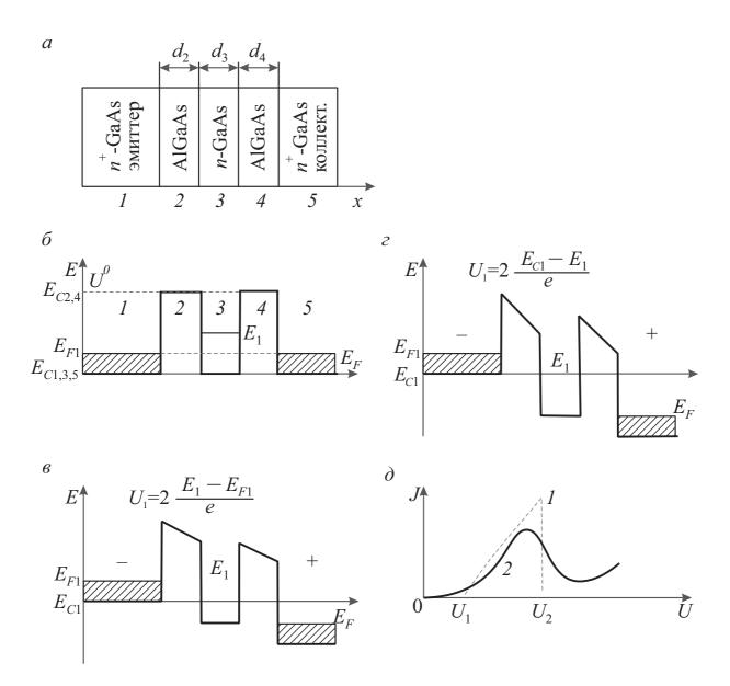
Рис. 7.7 — Структура (a), энергетические диаграммы ( $\delta$ ,  $\epsilon$ ,  $\epsilon$ ) и вольт-амперные характеристики ( $\delta$ ) резонансно-туннельного диода: пунктир на рисунке 7.7,  $\delta$  — идеализированная характеристика, сплошная кривая — реальная характеристика
