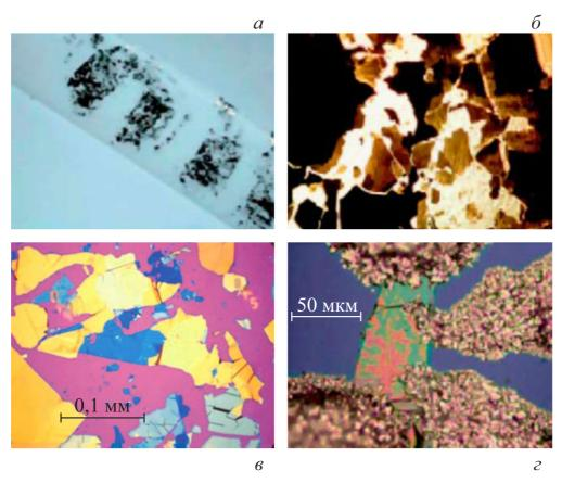
Рис. 8.1 - a) следы ВОПГ, оставшиеся на скотче;  $\delta$ ) некоторые кристаллики оптически прозрачны, если взглянуть на них через оптический микроскоп или даже через увеличительное стекло;  $\epsilon$ ) на подложке из оксида кремния светопроницаемые кристаллики дают различные оттенки голубого цвета;  $\epsilon$ ) одно из самых первых устройств, изготовленное вручную в лабораторных условиях с помощью пинцета, зубочистки и серебряной пасты для электрических контактов [108]
