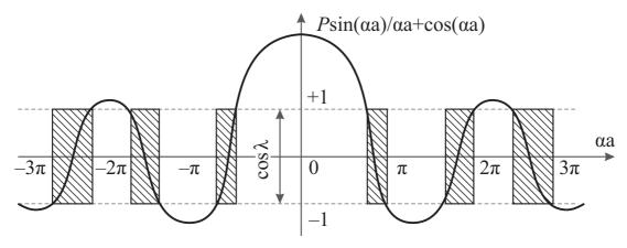
Рис. 3.2 – Разрешенные (заштрихованные) и запрещенные (светлые) зоны
