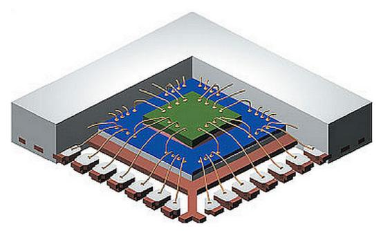
Рис. 1.6 – Сборка многослойной трехмерной микросхемы
