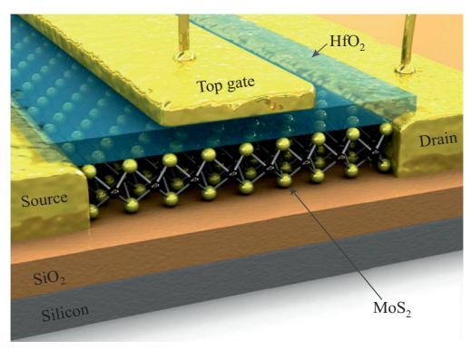
Рис. 7.21 — Молибденитовый полевой транзистор: source — исток, drain — сток, Тор gate — затвор,  $HfO_2$  — диэлектрик оксид гафния
