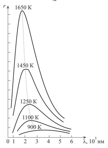
Рис. 2.1 — Спектральное распределение  $r(\lambda, T)$  при различных T
