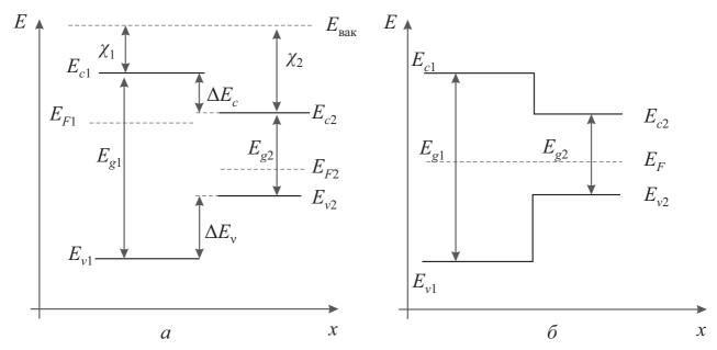
Рис. 4.2 – энергетическая диаграмма при формировании гетероперехода: a) до контакта и  $\delta$ ) после контакта
