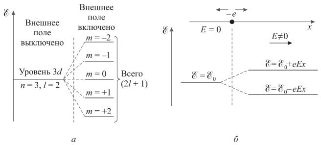
Рис. 2.9 — Снятие вырождения: a) под действием магнитного поля;  $\delta$ ) под действием электрического поля E
