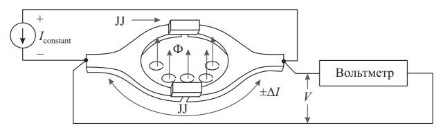
Рис. 6.12 – Два джозефсоновских перехода внутри сверхпроводникового кольца. Изменение потока вызывает изменение напряжения на паре джозефсоновских переходов. JJ – Josephson Junction – с англ. «джозефсоновский переход»
