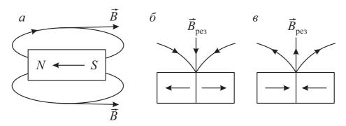
Рис. 6.19 — Направления линий вектора магнитной индукции  $\vec{B}$  одного домена (a) и на границе двух доменов  $\vec{B}_{\rm pes}$   $(\delta)$  и  $(\epsilon)$
