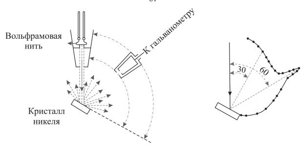
Рис. 2.6 — Экспериментальная установка для исследования рассеяния электронов кристаллом и типичная кривая, показывающая пучок правильно отраженных электронов. Бомбардирующий потенциал 83 вольта; угол падения пучка электронов 30 градусов [59]
