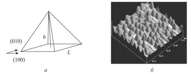
Рис. 5.3 — Островки PbSe на поверхности PbTe: a) схема островка;  $\delta$ ) схематическое изображение островков, полученное с помощью атомно-силового микроскопа
