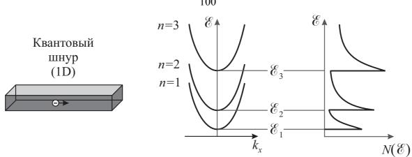
Рис. 3.6 – Одномерная низкоразмерная структура, ее энергетическая диаграмма и плотность состояний  $N(\mathcal{E})$
