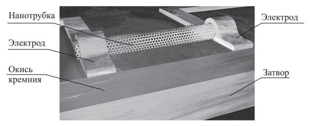
Рис. 7.25 – Схема полевого транзистора на УНТ
