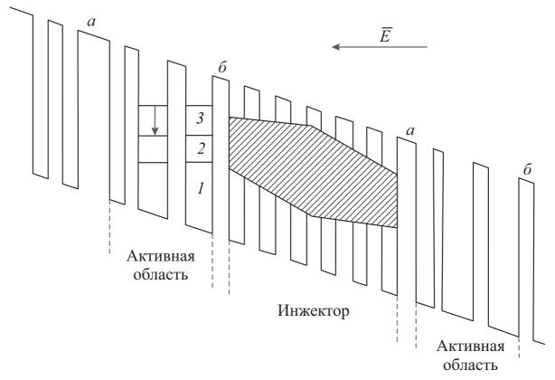
Рис. 7.15 – Схема, поясняющая работу квантового каскадного лазера
