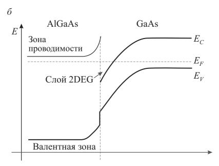
Рис. 7.18 – Типичная структура GaAs ГПТШ (a); его зонная диаграмма ( $\delta$ )
