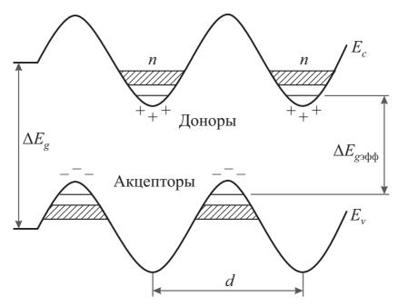
Рис. 4.6 — Энергетические диаграммы легированной сверхрешетки:  $\Delta E_{g ext{-}\phi}$  — эффективная ширина запрещенной зоны сверхрешетки; d — ее период
