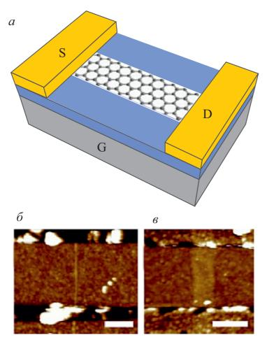
Рис. 8.5-a) структура и внешний вид графенового полевого транзистора. Схема GNRFETs с использованием 10 нм  $SiO_2$  и Pd стоком-истоком,  $p^{++}$ — Si использовался как нижний затвор;  $\delta$ ) AFM изображение структуры с шириной полоски графена  $\omega \sim 2 \pm 0.5$  нм, длиной канала L=236 нм. Метка измерительной линейки (белая прямоугольная полоска) — 100 нм;  $\epsilon$ ) AFM изображение структуры с  $\omega \sim 60 \pm 5$  нм, длиной канала L=190 нм. Измерительная линейка — 100 нм
