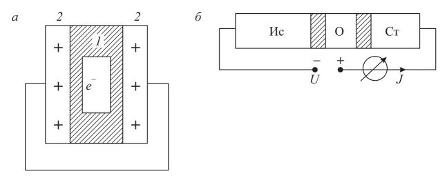
Рис. 6.15 — Структура, включающая два электрода и расположенный между ними в диэлектрической среде наноостровок в отсутствие (a) и при наличии ( $\delta$ ) напряжения между электродами Ис и Ст [77]
