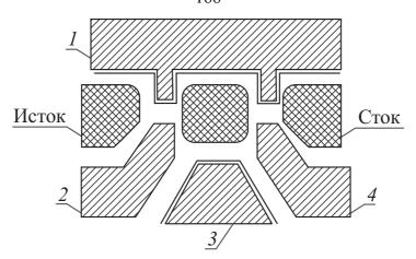
Рис. 7.3 — Расположение поверхностных затворов (1—4) на структуре с двумерным электронным газом для создания стандарта силы тока [78]
