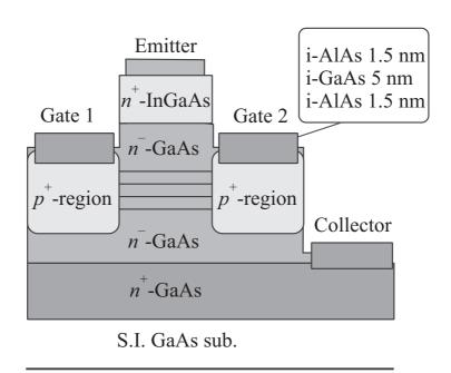
Рис. 7.9 – Управляемый затвором резонансно-туннельный диод на основе GaAs – AlAs
