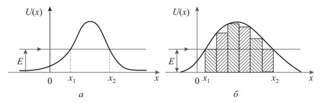
Рис. 6.8 — Барьер произвольной формы (*a*) и его представление в виде последовательности большого числа узких прямоугольных потенциальных барьеров, расположенных один за другим ( $\delta$ )
