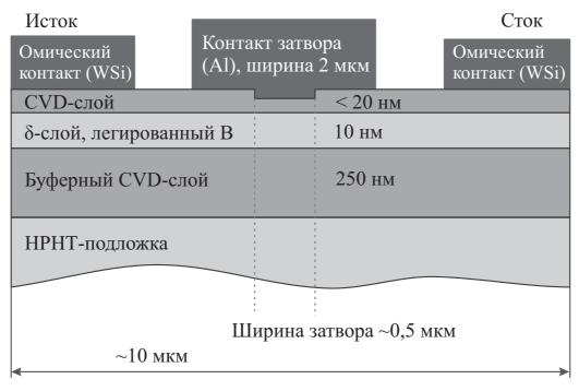
Рис. 7.22 – Структура первого MESFET-транзистора на основе алмаза с δ-слоем, легированным бором [101]
