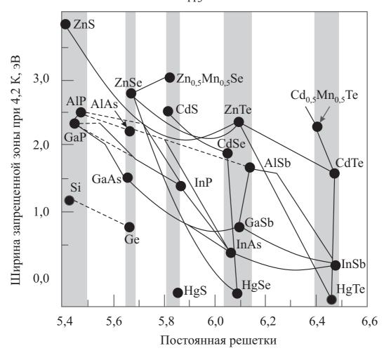
Рис. 4.1 – График зависимости энергии запрещенной зоны при низкой температуре от постоянной решетки для ряда полупроводников со структурой алмаза и цинковой обманки. Затененные области объединяют группы полупроводников с близкими значениями постоянных кристаллических решеток. Полупроводники, соединенные сплошными линиями, образуют между собой стабильные твердые растворы. Штриховые линии указывают на непрямые запрещенные зоны
