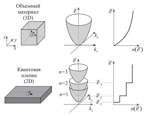
Рис. 3.5 — Двумерная низкоразмерная структура, ее энергетическая диаграмма и плотность состояний  $N(\mathcal{E})$  в сравнении с трехмерной структурой
