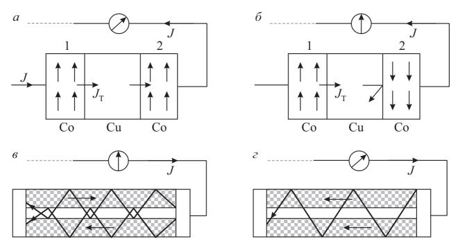
Рис. 6.18 – Схемы, поясняющие механизм ГМС
