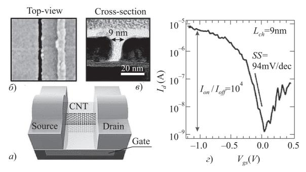
Рис. 7.27 - a) модель транзистора: затвор (gate), исток (source), сток (drain), УНТ (CNT);  $\delta$ ) вид сверху;  $\epsilon$ ) поперечное сечение (Cross section);  $\epsilon$ ) электрические характеристики [106]
