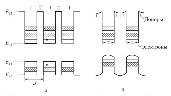
Рис. 4.5 — Энергетические диаграммы простой композиционной (a) и модулированной ( $\delta$ ) сверхрешеток; d — период решетки
