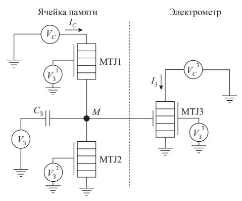
Рис. 7.5 – Структурная схема ячейки памяти на одноэлектронных транзисторах
