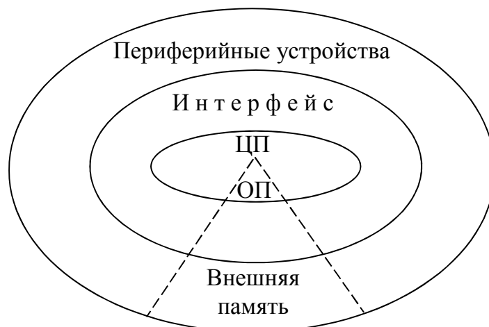
Рис. 3.1 – Структура компьютера: ЦП – центральный процессор; ОП – основная первичная память, включающая: регистры процессора, СОЗУ, ОЗУ и ПЗУ (BIOS)
