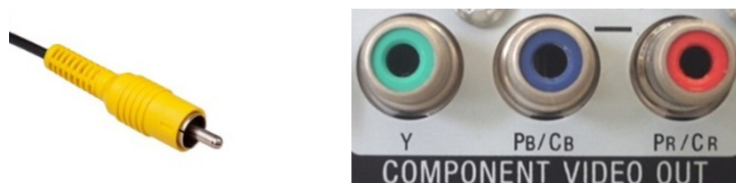
Рис. 3.21 – Порты видеоподсистемы: композитный видеовыход (слева); компонентный видеовыход Y-Pb-Pr (справа)
