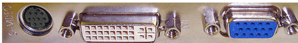
Рис. 3.20 – Порты видеоподсистемы (слева направо): 9-контактный разъём S-Video TV-out, DVI и D-sub
