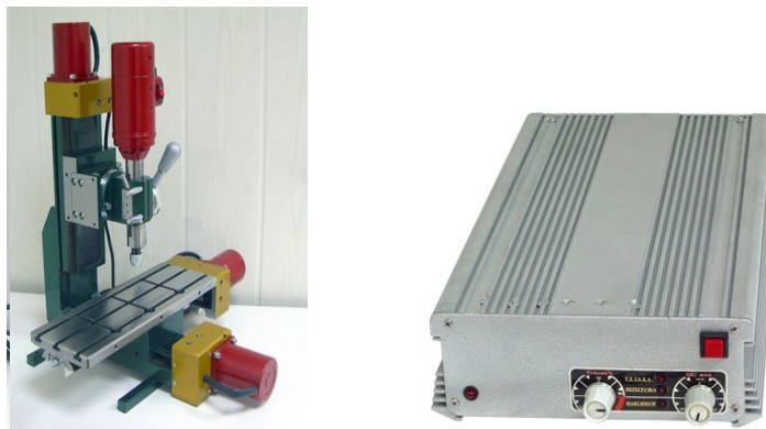
Рис. 4.6 – Фрезерно-сверлильный станок и блок управления им (контроллер)
