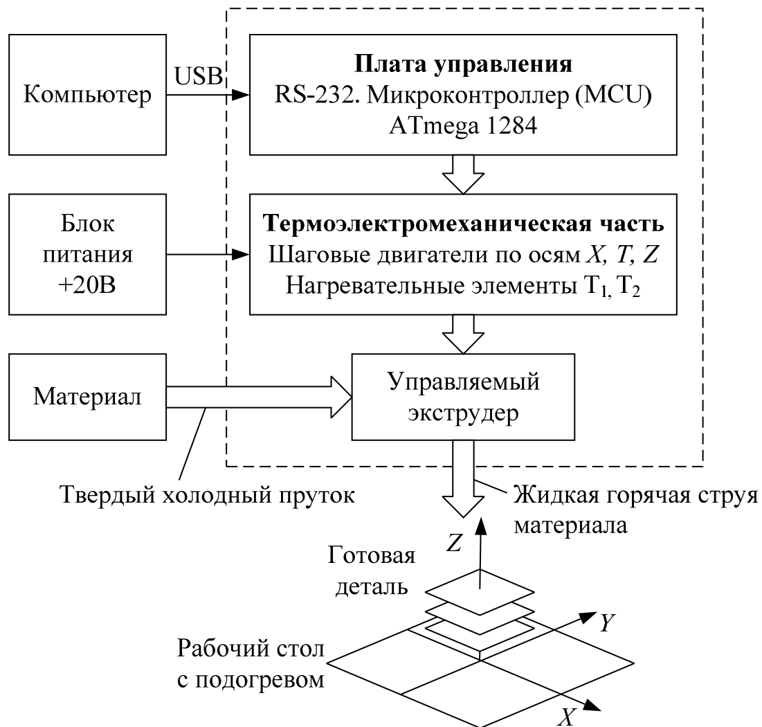
Рис. 4.11 – Структурная схема 3D-принтера RepRap Prusa Mendel v2.0
