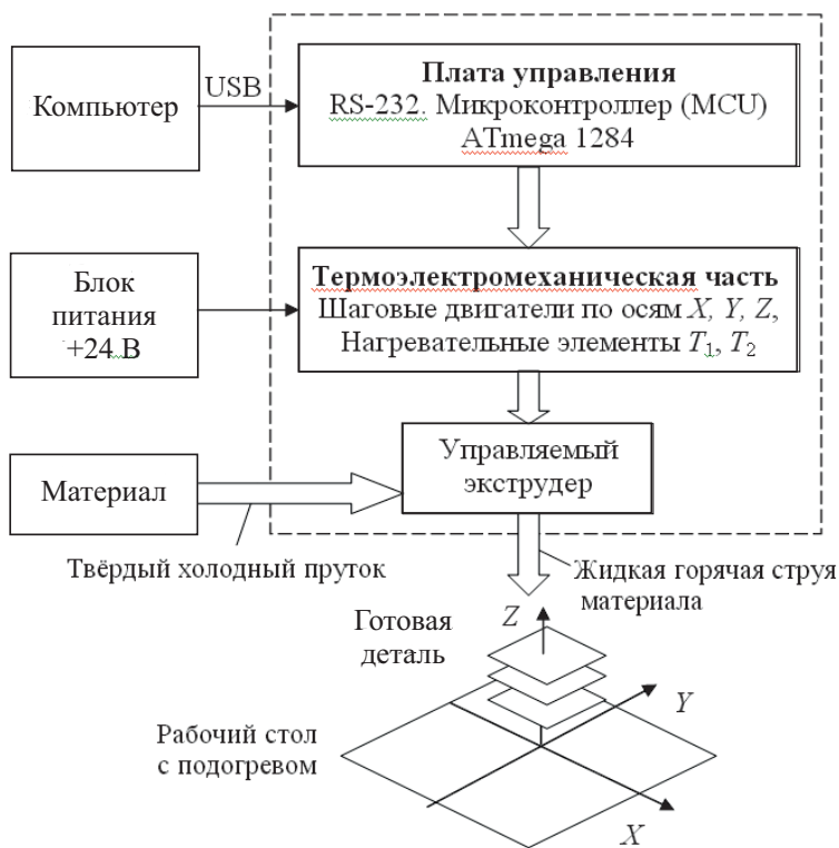
Рисунок 4.11 – Структурная схема 3D-принтера RepRap Prusa Mendel v2.0
