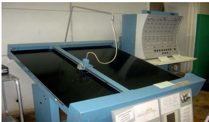
Рисунок 4.1 – Графическое регистрирующее устройство типа ЕС-7051М (СССР, 1980 –1983 гг.). Скорость вычерчивания 50 мм/с. Автоматически чертит на бумажных носителях схемы, карты и другие документы по данным, поступающим от ЭВМ или устройств подготовки данных (Политехнический музей, Москва, 2011 г.)
