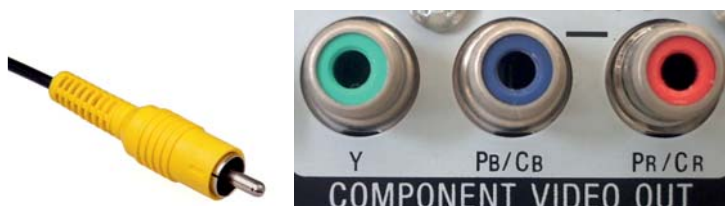
Рисунок 3.20 – Порты видеоподсистемы: композитный видеовыход (слева); компонентный видеовыход Y–Pb–Pr (справа)
