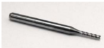
Рисунок 4.7 – Технологическая оснастка и режущий инструмент: a – цанговый зажим; б – концевая фреза
