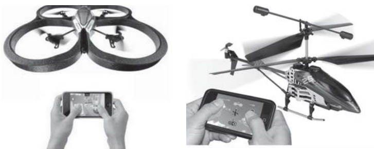
Рисунок 3.2 – Планшетные компьютеры в качестве пультов управления периферийными устройствами в виде беспилотных летательных аппаратов (дронов)
