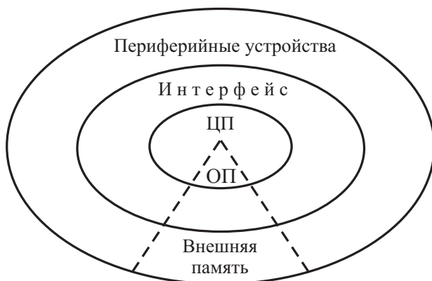
Рисунок 3.1 – Структура компьютера: ЦП – центральный процессор; ОП – основная первичная память, включающая регистры процессора, СОЗУ, ОЗУ и ПЗУ (BIOS)
